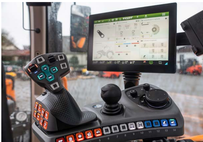
NEW GENERATION: Das zentrale Display samt Bedienelemen- ten der aktuellen Fendt Generation.
