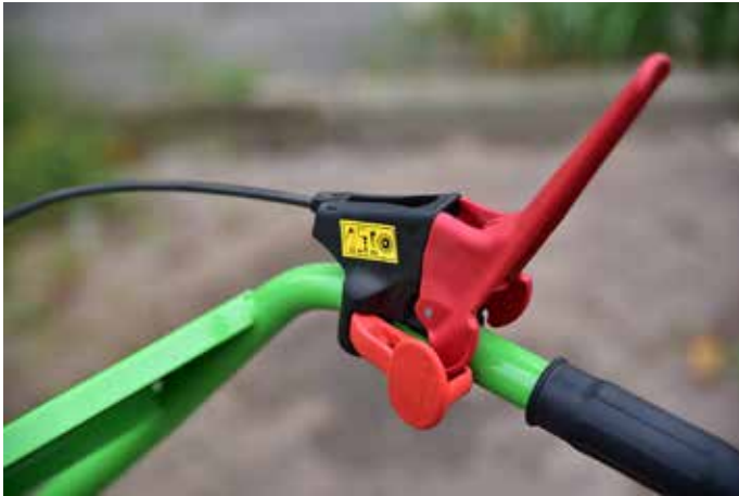
Der Bürstenantrieb wird über einen Hebel am rechten Holm gestartet.
