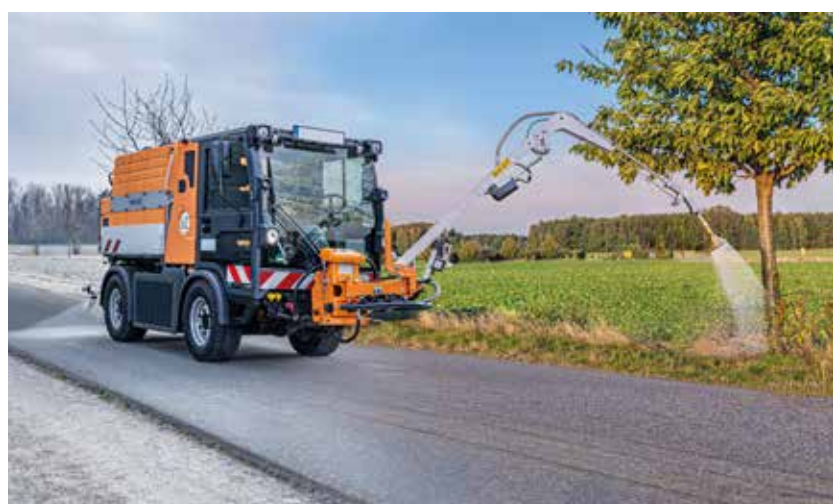
Tanksystem FTS 5000 mit Gießarm FGA 1000 und Weitwurfdüsen am Tank
