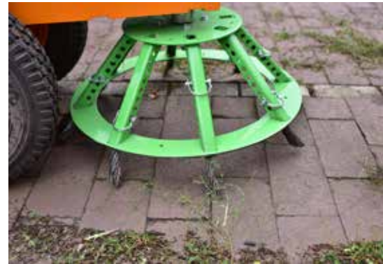
Die Bürstenträger der beiden Geräte sind identisch. Sie verfügen jeweils über acht werkzeugfrei einzeln nachstell- und austauschbare Bürstenzöpfe.
