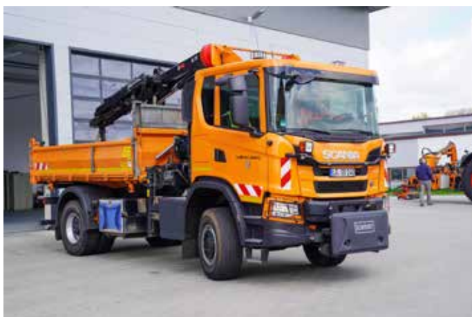
KONFIGURIERT FÜR DEN STRASSENBETRIEBSDIENST: Die G-Baureihe von Scania als 2-Achser mit Kipper, Ladekran und Kommunalplatte.
