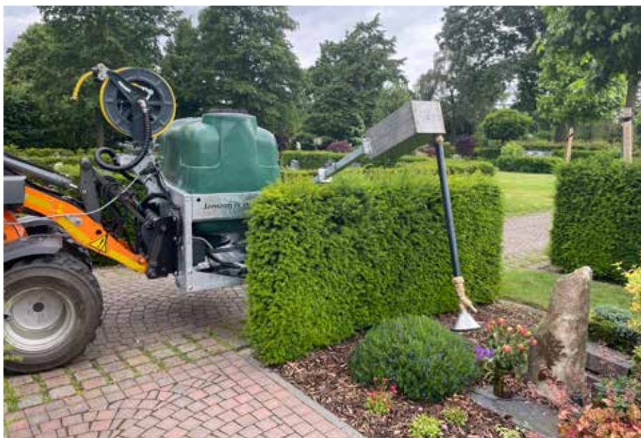
Auf dem elektrisch betriebenen Weidemann Hoflader sitzt ein 1.000-Liter-Tank-Aufbau von Jansing & Hidding. Mit dem System wird der städtische Friedhof bewässert.
