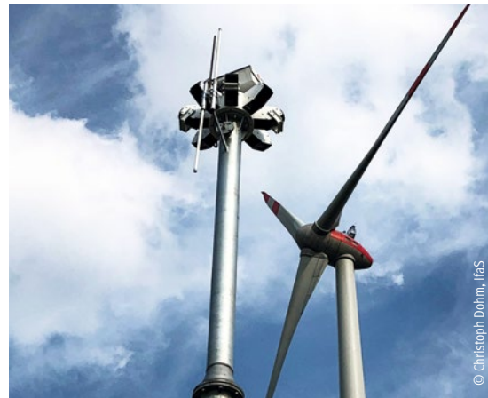
Abbildung 5.18: Kamerasystem zum Schutz von Rotmilanen im Windpark Bütow
