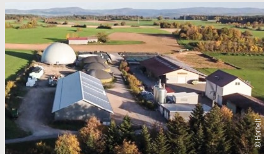
Abbildung 5.4: Auf dem Haslachhof werden neben Biogetreide, Hirse, Buchweizen und Fleisch vom Hinterwälderrind, auch Biodiversität, Strom und Nahwärme für die Stadt Löffingen produziert. Im Hintergrund ist der Gasspeicher (hellgraue Kuppel) zu sehen. Durch diesen und große Wärmespeicher ist es möglich, den Betrieb der Blockheizkraftwerke flexibel am tagesaktuellen Energiebedarf zu orientieren und so einen weiteren Beitrag zur Energiewende zu leisten.
