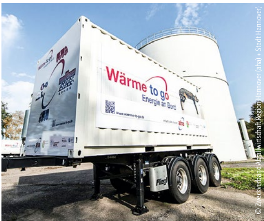
Abbildung 4.20: Modellprojekt mobiler Wärmespeicher des Zweckverbands Abfallwirtschaft Region Hannover (aha) mit einer Elektro-Zugmaschine, Wärmetransport von einer Abfallbehandlungsanlage (Wärmeerzeugung) zu einem Schulstandort (Wärmenutzung)
