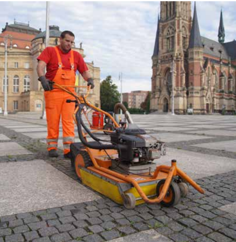
MECHANISCHE WILDKRAUT-BESEITIGUNG: Mit dem Gerät der Fa. AS-Motors wird das Wildkraut „weggebürstet“ und sofort aufgenommen.
