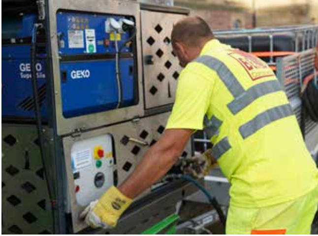
AUF TEMPERATUR GEBRACHT: Mit Hilfe des Wärmegerzeugers wird das Wasser auf rund 110 °C erhitzt.
