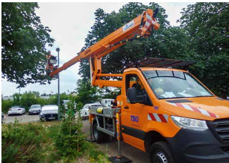
Eine der beiden Hubarbeitsbühnen der Technischen Betriebe Offenburg: Die Teleskophubarbeitsbühne hat eine Arbeitshöhe von 18 m.
