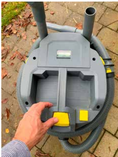
Der Ein-Aus-Schalter. Daneben der Taster für die Abreinigung des Flachfaltenfilters.
