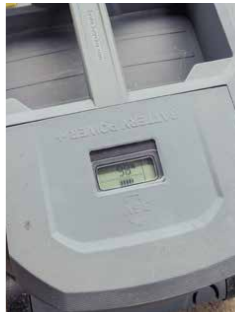
Der Ladestand der Akkus wird in Prozent angezeigt, während des Betriebs ist die Restlaufzeit zu sehen.
