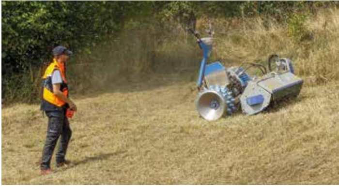
Der Brielmaier ist ein Einachsgeräteträger, der auch mit Funk ausgerüstet werden kann.
