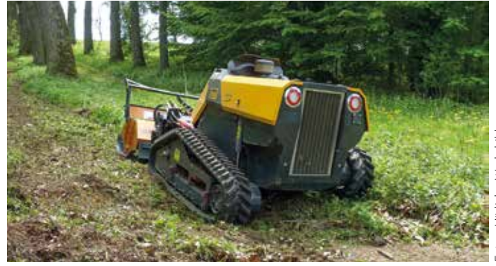
Die Besonderheit bei der Herder-Raupe, die von Wilmers Kommunaltechnik vertrieben wird, ist das höhenverstellbare Fahrwerk.
