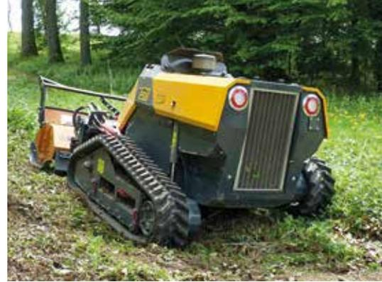
In der mittleren Einstellung nivellieren sich die beiden Laufwerke unabhängig voneinander.
