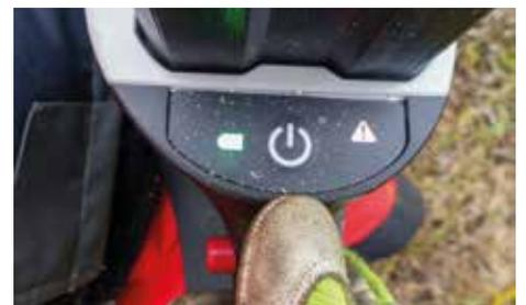
Aktiviert wird die Säge mit Druck auf einen Folientaster.
