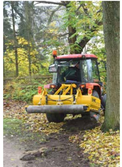
Dank der seitlichen und hinteren Schürfleisten kann das Gerät auch zum Entfernen des Grünbewuchses genutzt werden.
