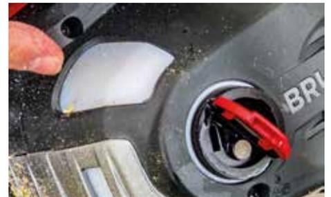
Das Schauglas für das Kettenöl kann von oben eingesehen werden. Der Tankverschluss funktioniert werkzeuglos.
