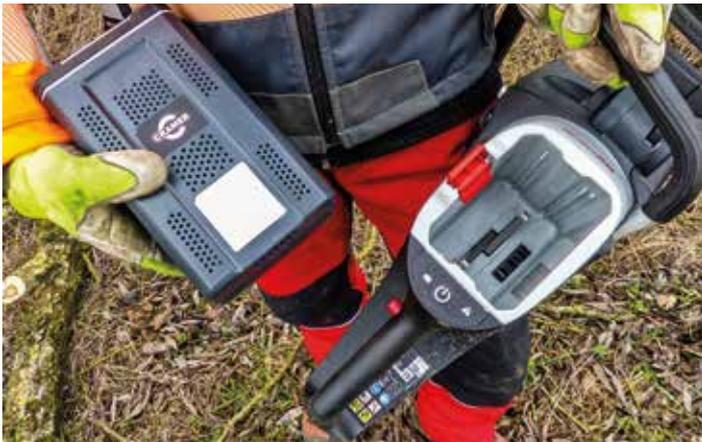
Cramer arbeitet bei den Profi-Akkugeräten mit einer Spannung von 82 V.
