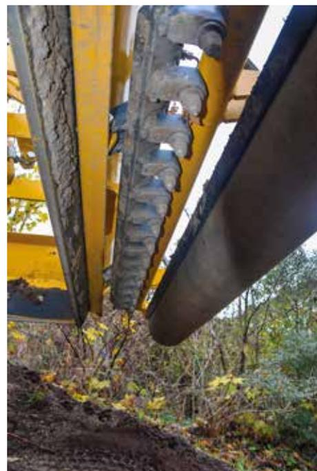
Ist die alte Deck- bzw. Ausgleichsschicht stärker beeinträchtigt, macht der Einsatz der Aufreißschiene Sinn. Je nach Verhärtung des Materials sind dazu auch zwei oder drei Überfahrten nötig, bevor die Arbeitsgänge Materialausgleich und Rückverfestigung folgen.
