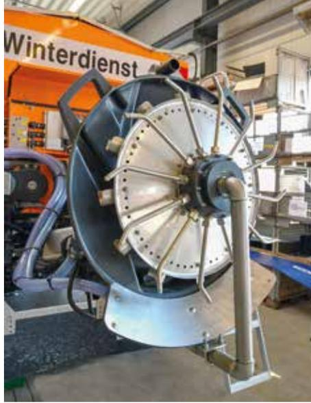
Mit dem BrineStar-System können ohne Spritzbalken 100 % Sole auf 12 m ausgebracht werden.
