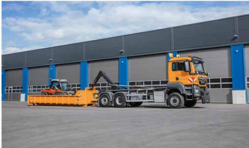
Alternative zum Kipper: Hakengeräte sorgen für ein Höchstmaß an Flexibilität und können unter anderem für den Transport von Arbeitsmaschinen genutzt werden.
