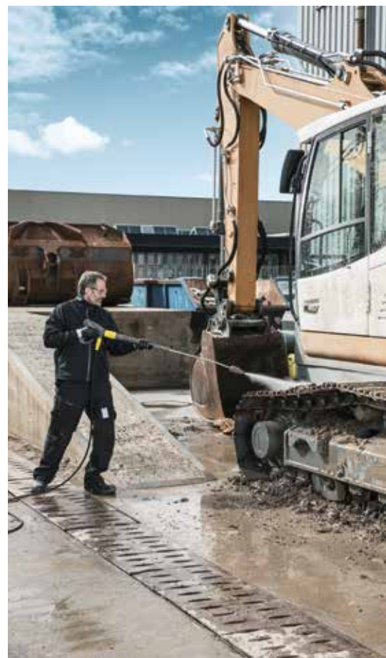
Die Beseitigung von Schmutz an Baumaschinen erfordert meist eine Hochdruckreinigung mit einem Kaltwassergerät mit mindestens 1.000 l.
