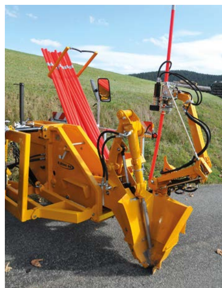
Die nächste Schneestange wird automatisch aus dem Ladekorb des Stickset 500 geholt.
