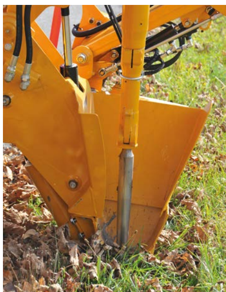
Das Stangenloch wird mit einem Meißel vorgebohrt.
