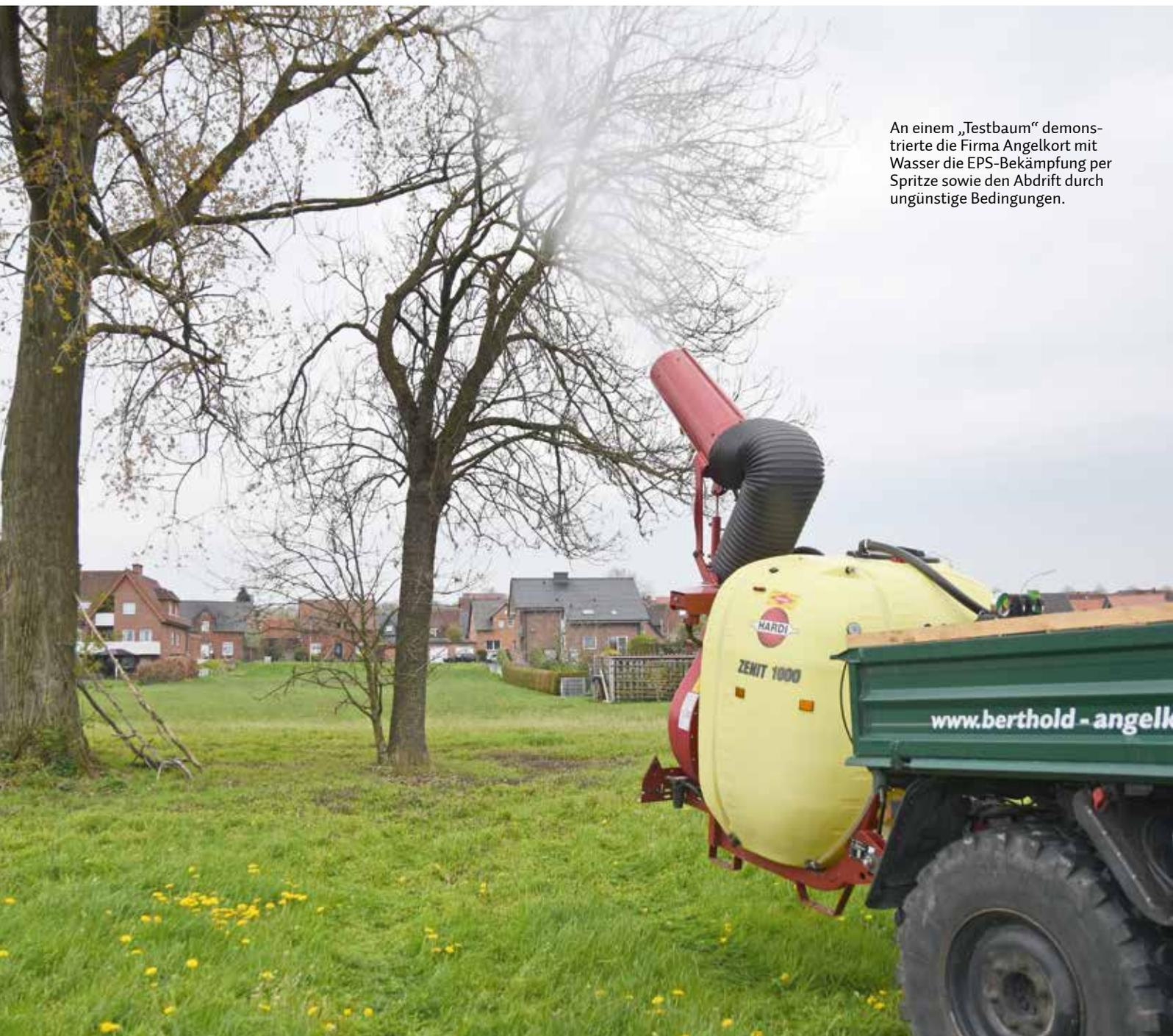
An einem „Testbaum“ demonstrierte die Firma Angelkort mit Wasser die EPS-Bekämpfung per Spritze sowie den Abdrift durch ungünstige Bedingungen.
