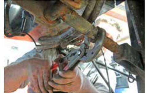
Nach dem Abkühlen lässt sich die Mutter spielend einfach lösen. Der Kabelbinder links von der Mutter hat die Aktion schadlos überstanden.
