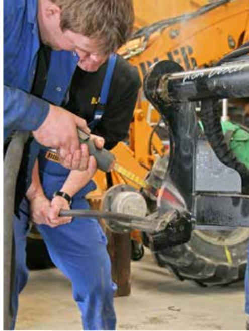
Erwärmt wird exakt an der zuvor mit Kreide markierten Knicklinie.
