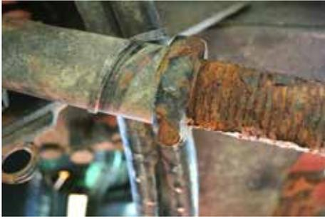
Selbst auf den ersten Blick „hoffnungslose Fälle“ lassen sich mit Induktionswärme leicht lösen.
