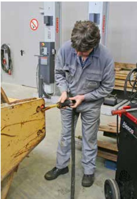
Selbst in einem Sackloch sitzende Schrauben, die fest sitzen, müssen vor dem Induktionserhitzer kapitulieren. Ein kurzer Wärmestoß bis zur Rotglut reicht ...
