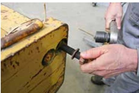
... um den Rost im Gewinde zu pulverisieren. Nach dem Aufglühen lässt man die Induktionshitze in das Schraubenmaterial hineinziehen und kann anschließend die Schraube einfach herausdrehen.
