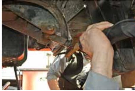
Mit dem Handstück des Induktionsheizers bringt man die Mutter an zwei bis drei Stellen innerhalb von Sekunden auf Rotglut.
