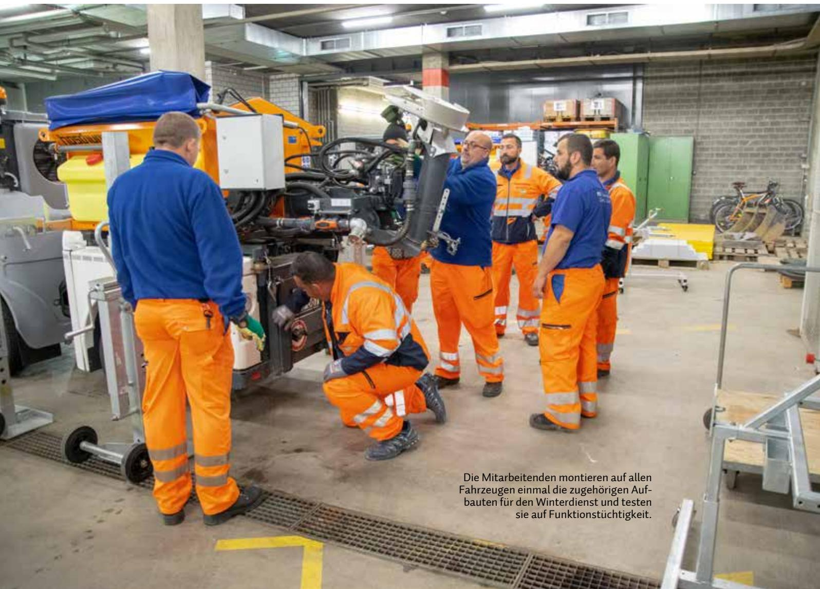
Die Mitarbeitenden montieren auf allen Fahrzeugen einmal die zugehörigen Aufbauten für den Winterdienst und testen sie auf Funktionstüchtigkeit.
