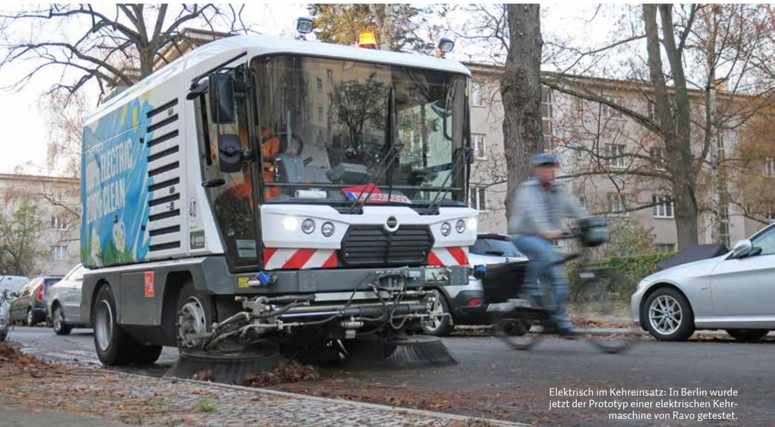
Elektrisch im Kehreinsatz: In Berlin wurde jetzt der Prototyp einer elektrischen Kehrmachine von Ravo getestet.
