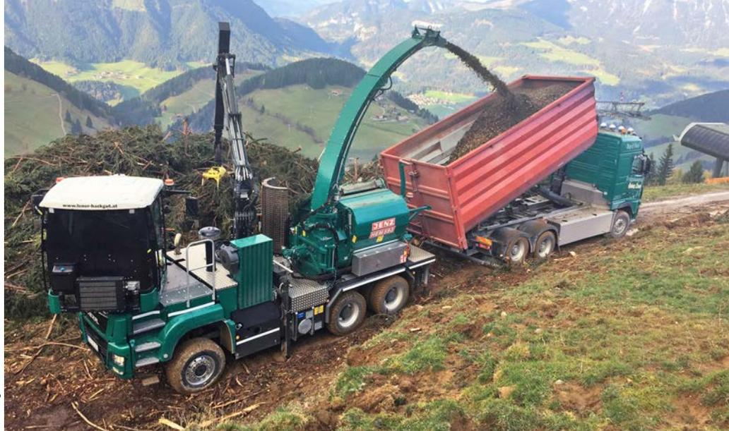
Hacken mit Panorama und drehbarer Kabine – der Chippertruck HEM 593 R Cobra.
