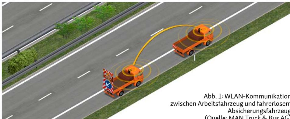
Abb. 1: WLAN-Kommunikation zwischen Arbeitsfahrzeug und fahrerlosem Absicherungsfahrzeug (Quelle: MAN Truck & Bus AG)
