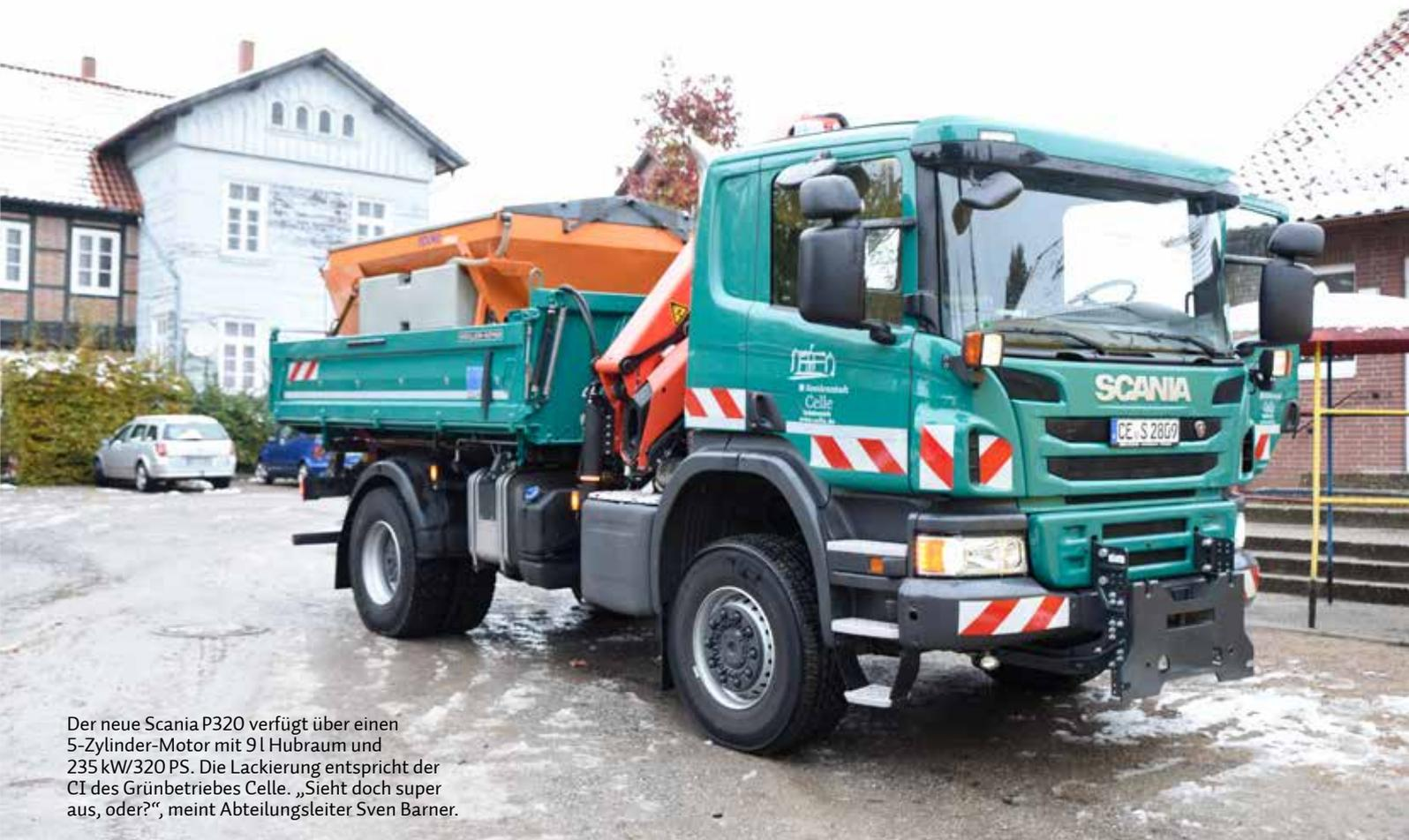
Der neue Scania P320 verfügt über einen 5-Zylinder-Motor mit 9 l Hubraum und 235 kW/320 PS. Die Lackierung entspricht der CI des Grünbetriebes Celle. „Sieht doch super aus, oder?“, meint Abteilungsleiter Sven Barner.
