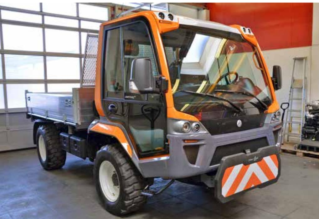
Transporter von einem Vierzylinder-Turbo-dieselmotor mit 107 PS Nennleistung. Für optimale Wendigkeit soll die 4-Rad-Lenkung des Unitrac stehen. Die Nutzlast liegt bei mehr als 5.000 kg. Fahrkomfort und Geländegängigkeit soll das Hochleistungsfahrwerk mit Einzelradaufhängung und hydraulischer Federung gewährleisten. Wie bereits aus der Unitrac-Serie bekannt, kann die Kabine des neuen Unitrac ohne Werkzeugeinsatz seitlich um 50 Grad gekippt werden.
