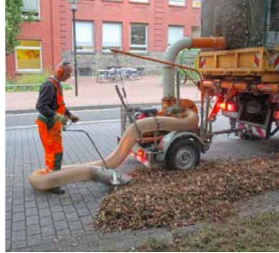
Ein Vorteil des Laubsaugers, der in Peine eingesetzt wird, ist, dass das Laub zerkleinert wird und damit das Volumen deutlich sinkt.
