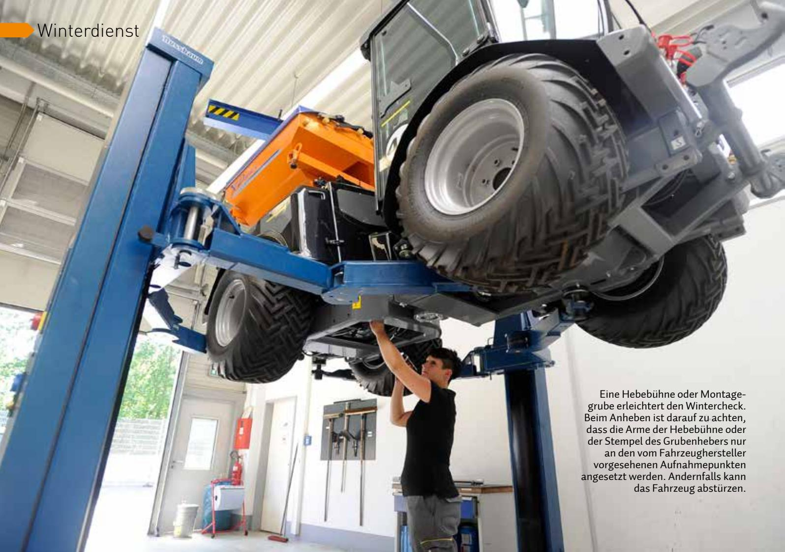
Eine Hebebühne oder Montagegrube erleichtert den Wintercheck. Beim Anheben ist darauf zu achten, dass die Arme der Hebebühne oder der Stempel des Grubenhebers nur an den vom Fahrzeughersteller vorgesehenen Aufnahmepunkten angesetzt werden. Andernfalls kann das Fahrzeug abstürzen.
