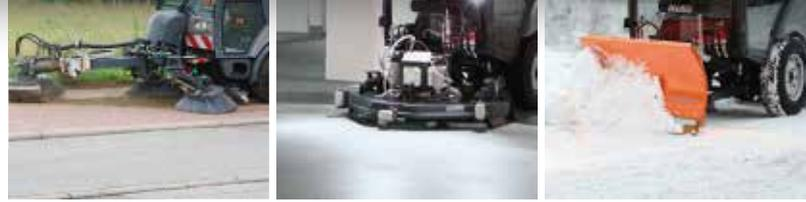
Der neue Citymaster 2200 – entwickelt für die Reinigung öffentlicher Flächen – leistet ein Höchstmaß an Wirtschaftlichkeit, Sicherheit und Flexibilität. Mit hochwertigen Komponenten, die den hohen Qualitätsansprüchen modernster Kommunaltechnik gerecht werden. Mit einer Motorleistung von 80 kW. Ausgerüstet mit einem 2- oder 3-Besen-Kehrsysteem und echten 2 m<sup>3</sup> Behältervolumen für zeiteffizientes Kehren.
