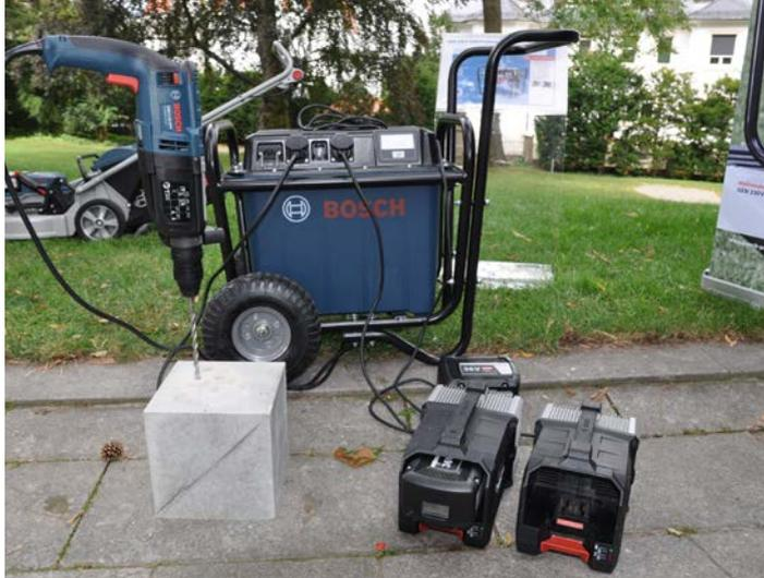
Mithilfe der mobilen Steckdose GEN 230V-1500 Professional sollen Akku-Geräte auch in Außenbereichen ohne Zugang zum Stromnetz ganztägig eingesetzt werden können.
