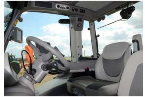
Die MaxiVision 2-Kabine verspricht Bedienkomfort, eine gute Übersicht und, dank der Trennung von Kabine und Motorhaube, hohen Schutz vor Lärm.
