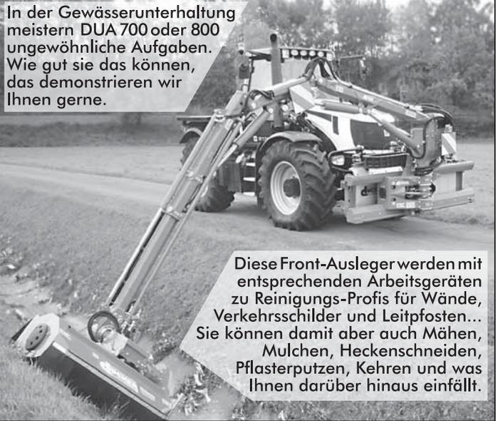
Diese Front-Ausleger werden mit entsprechenden Arbeitsgeräten zu Reinigungs-Profis für Wände, Verkehrsschilder und Leitpfosten... Sie können damit aber auch Mähen, Mulchen, Heckenschneiden, Pflasterputzen, Kehren und was Ihnen darüber hinaus einfällt.
