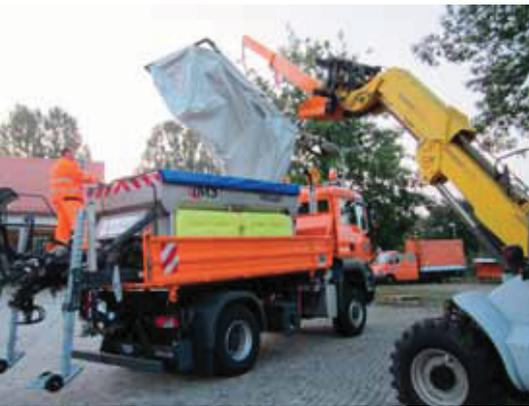
Die Autobahnmeisterei Erkner setzt mittlerweile auf ein Wechselsystem, mit dem zwischen Salz- und Soleausbringung gewechselt werden kann.
