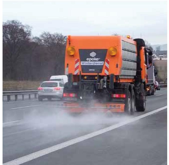
Bei Streuversuchen wurde festgestellt, dass durch die Ausbringung von Sole (rechts) im Verhältnis zur Feuchtsalzstreuung (links) eine Menge Salz eingespart werden kann. (Bilder: Hausmann)
