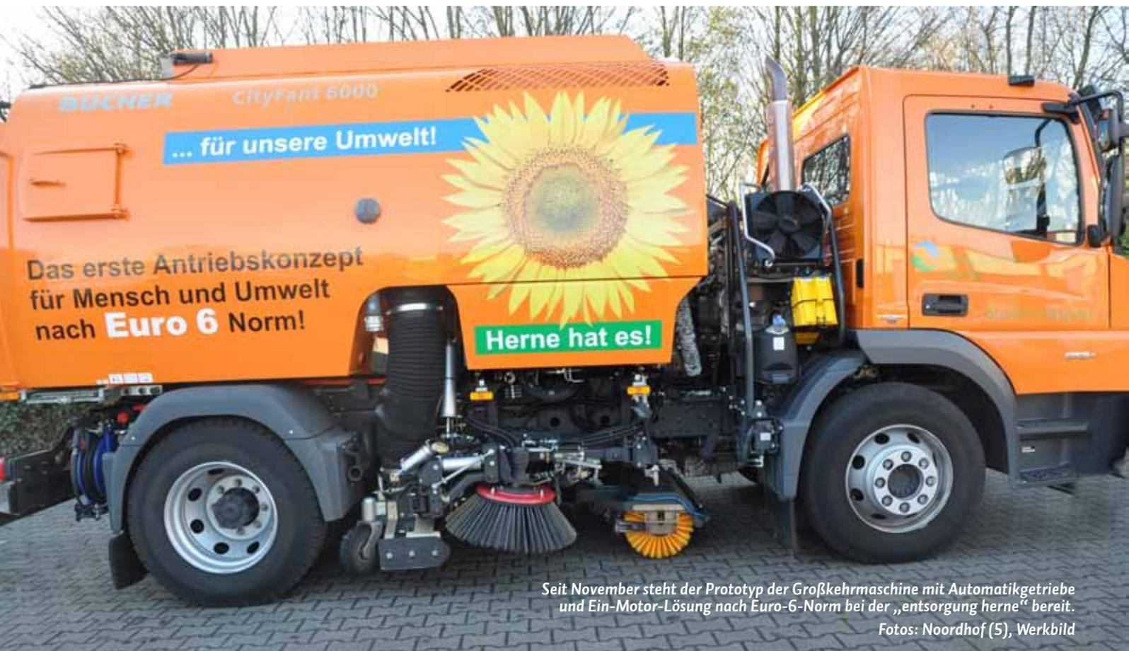
Seit November steht der Prototyp der Großkehrmaschine mit Automatikgetriebe und Ein-Motor-Lösung nach Euro-6-Norm bei der „entsorgung herne“ bereit.
