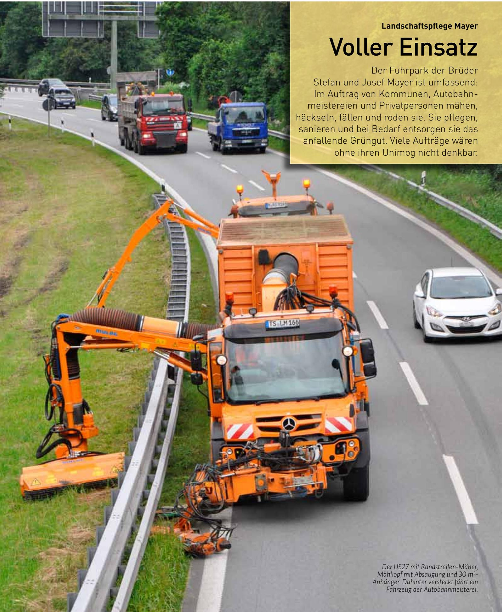
Der U527 mit Randstreifen-Mäher, Mähkopf mit Absaugung und 30 m<sup>3</sup>-Anhängen. Dahinter versteckt fährt ein Fahrzeug der Autobahnmeisterei.
