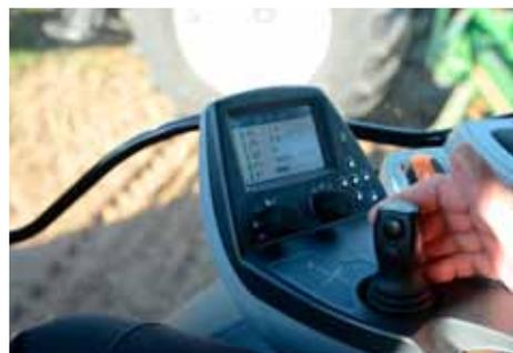
Alles im Blick: Die Versu- und Direct CVT-Modelle sind mit ARM-Armlernen mit Display ausgerüstet.
