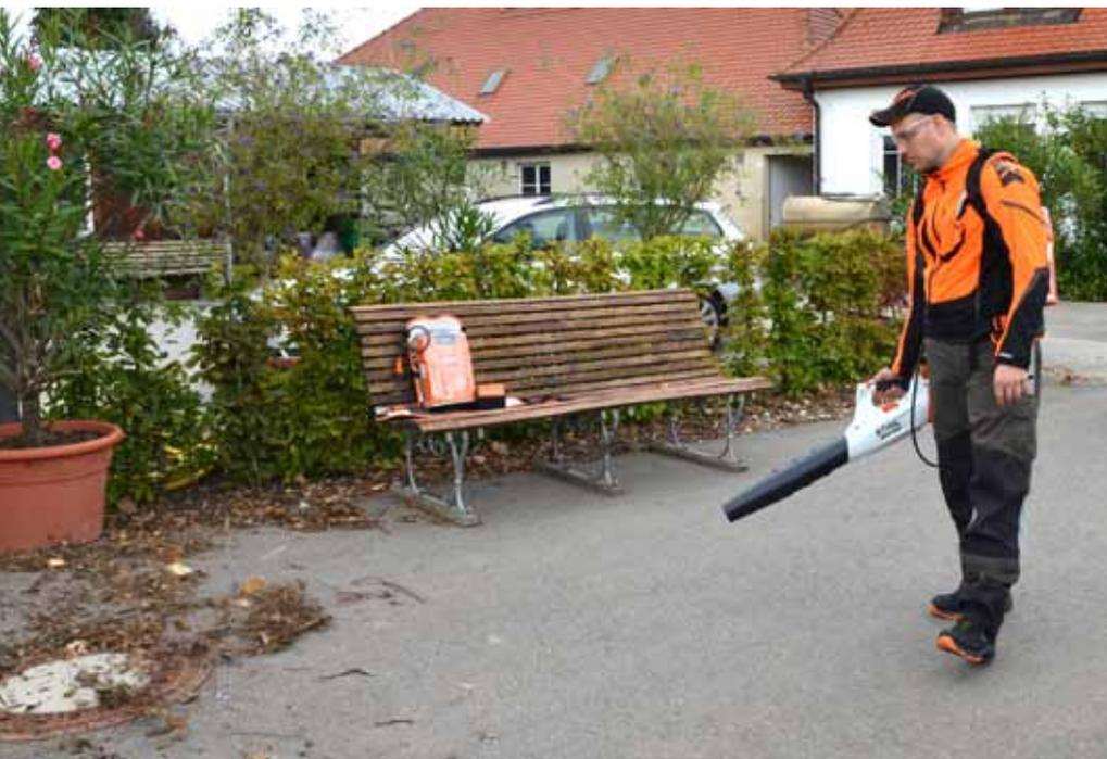
Das neue Stihl Blasgerät BGA 100 wiegt nur 2,5 kg und wird über einen rückentragbaren Akku angetrieben, der Arbeiten bis zu 6,5 h ermöglichen soll.
