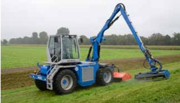
Berky bietet einen Trac an, der speziell für Arbeiten in der Gewässerunterhaltung konzipiert wurde. Die Kabine lässt sich um 270° drehen. Somit hat der Fahrer das Arbeitsgerät optimal im Blick.
