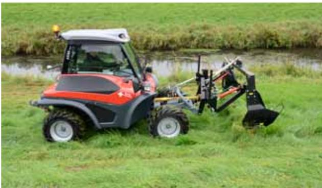
Auf Deichen und Dämmen lassen sich Hang-Geräteträger wie zum Beispiel der TT 211 von Aebi einsetzen. Der angebaute Mähbalken ist 2,1 m breit.
