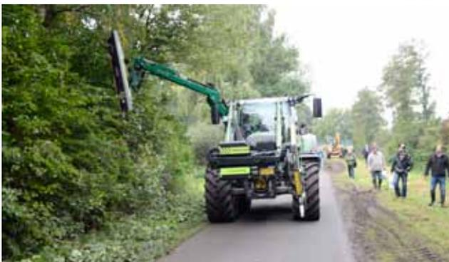
Spearhead zeigte den Mähhausleger Twiga Flex 6000 T. Dieser kann unter anderem mit einer Kreissäge zur Gehölzpflege eingesetzt werden.
