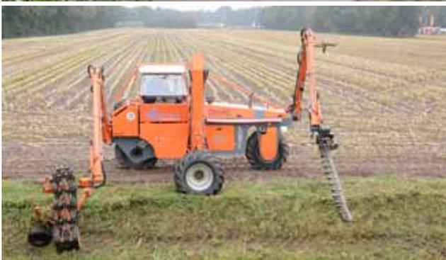
Der Böschungsmäher Conver C10S kann mit einem 2,85-m-Mähbalken ausgerüstet werden. Im Heck wird eine 3,2 m breite Harke gefahren, die das Mähgut auf der Grabenkante ablegt.
