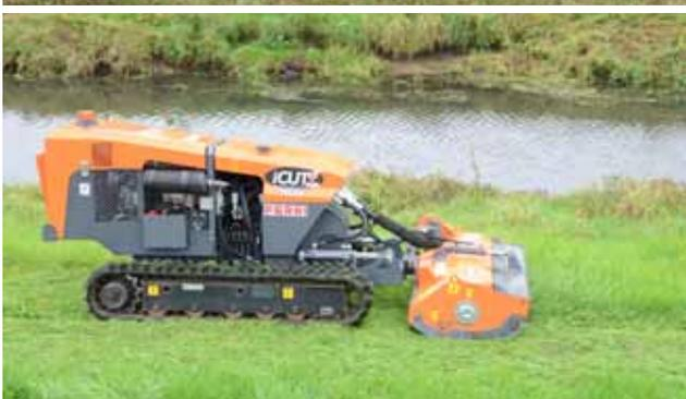
Der ferngesteuerte Böschungsmäher Cut 4/Flex von Ferri verfügt über einen 49 PS Isuzu-Motor. Das Laufwerk lässt sich in der Breite hydraulisch verstellen um die Hangtauglichkeit zu maximieren.
