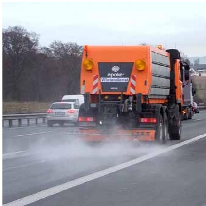
Bei Streueversuchen wurde festgestellt, dass durch die Ausbringung von Sole (rechts) im Verhältnis zur Feuchtsalzstreuung (links) eine Menge Salz eingespart werden kann. (Bilder: Hausmann)
