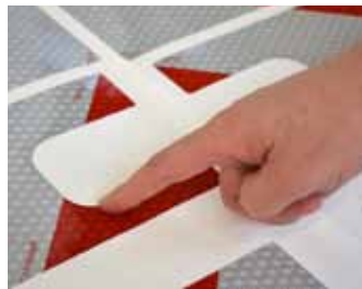
Für die gängigen Fahrzeugtypen sind fertig zugeschnittene Folien-Sets lieferbar. Dabei sind je nach Modell auch Aussparungen für Blinker (kleines Foto) und Heckklappengriffe berücksichtigt.
