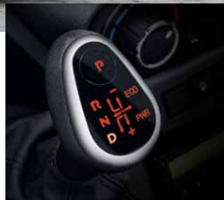
Das Hi-Matic-Getriebe des Daily lässt verschiedene Fahr-Modi zu: „Eco“, „Power“ und einen manuellen Getriebemodus.
