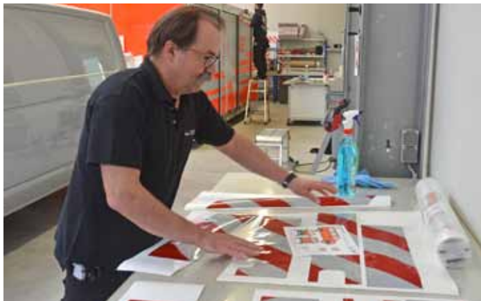
Für die gängigen Fahrzeugtypen sind fertig zugeschnittene Folien-Sets lieferbar. Dabei sind je nach Modell auch Aussparungen für Blinker (kleines Foto) und Heckklappengriffe berücksichtigt.
