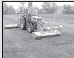
Damit eröffnen sich neue Einsatzmöglichkeiten auf Flächen, von denen bisher der Grünschnitt eingesammelt und abtransportiert werden mußte.
