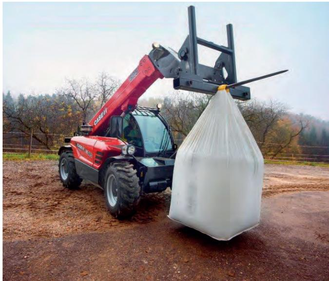
elektronischen Proportionalventilen feinfühlig ansteuern lassen. Mit einer Hubhöhe von maximal 9 m ist der Farmlift für verschiedene Arbeiten, zum Beispiel auch als mobile Arbeitsbühne mit Korb, einsetzbar und kann somit diverse Maschinen im Fuhrpark ersetzen.
