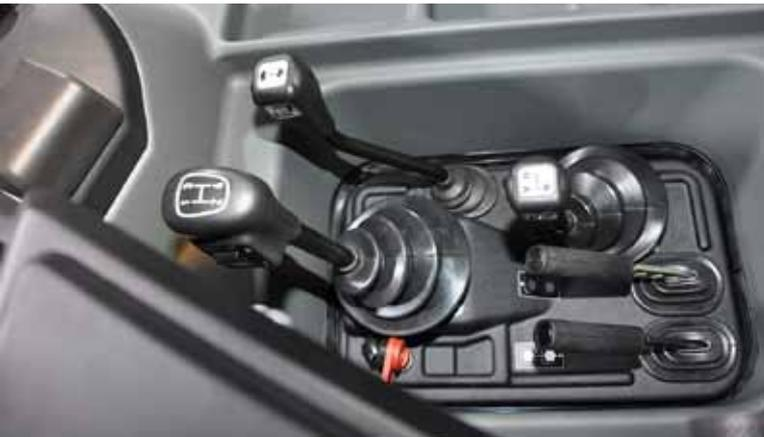
Der Hebel rechts oben dient zur Umschaltung zwischen den beiden Getriebevarianten.
