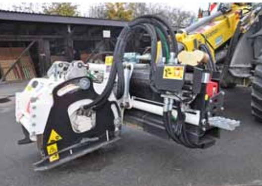
Der Kramer Radlader wurde speziell für die Fräse gekauft, aber er wird natürlich auch für andere Arbeiten genutzt. Das An- und Abbauen der Fräse geht einfach und schnell. Das abgefräste Material wird von der Kehmaschine aufgenommen, am Bauhof zwischengelagert und dann über ein Spezialunternehmen entsorgt.
