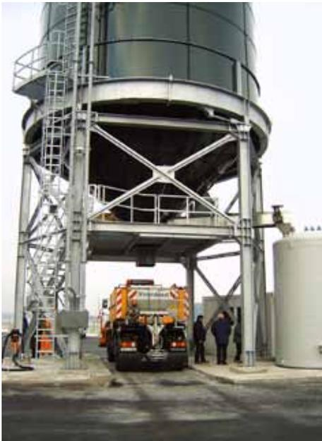
Soleerzeuger, der direkt aus einem Silo mit Salz beschickt wird.
