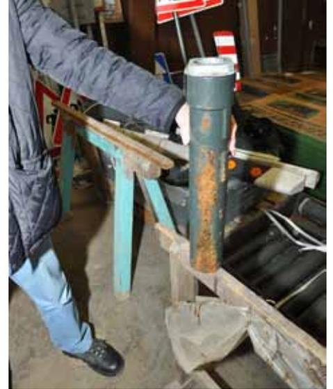
Diese Hülsen für die Verkehrszeichen werden einbetoniert und erleichtern den schnellen Wechsel der Schilder mit Masten.
