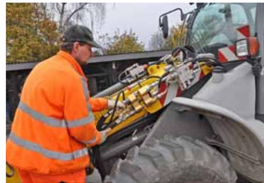
An- und Abbau der Fräse vom Teleskoplader geht schnell, auch wegen der zentralen Steckverbindung der Hydraulikleitungen.
