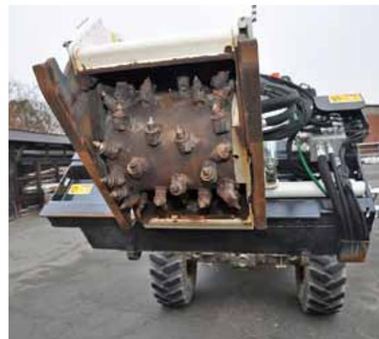
Die Arbeitsbreite der Simex-Fräse beträgt 45 cm. Die Fräsköpfe lassen sich einzeln austauschen.
