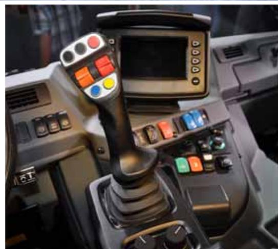
Neu ist die Bedieneinheit mit Joystick und Display.
