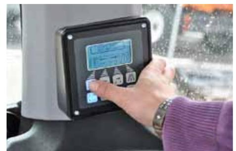
Vier verschiedene Lenkungsarten können mit Drucktastern auf dem an der B-Säule angebrachten Terminal gewählt werden. Fotos: Engeler
