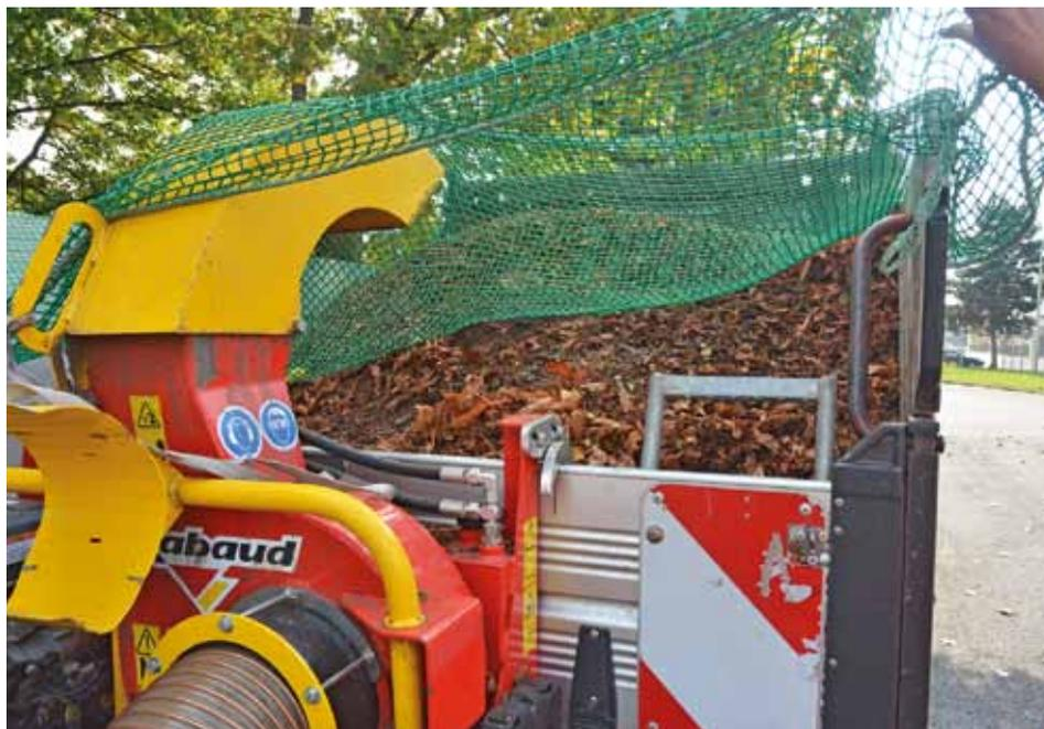
Motor, Turbine und Saugschlauch lassen sich an der Heckbordwand des Transporters „anhängen“.
