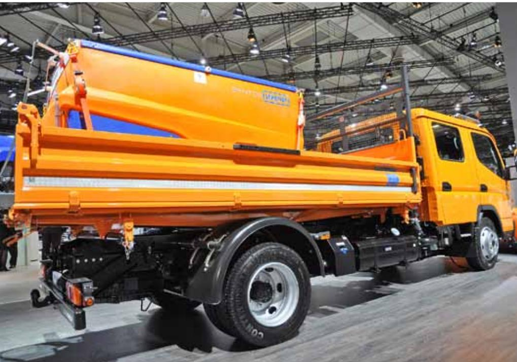
maximale Zuladung von 960 kg Trockenstreugut und weiteren 350 Litern Sole. Beide Streugeräte lassen sich optional auch über eine Bluetooth-Schnittstelle bequem und ohne störende Kabel vom Fahrerhaus aus bedienen.
