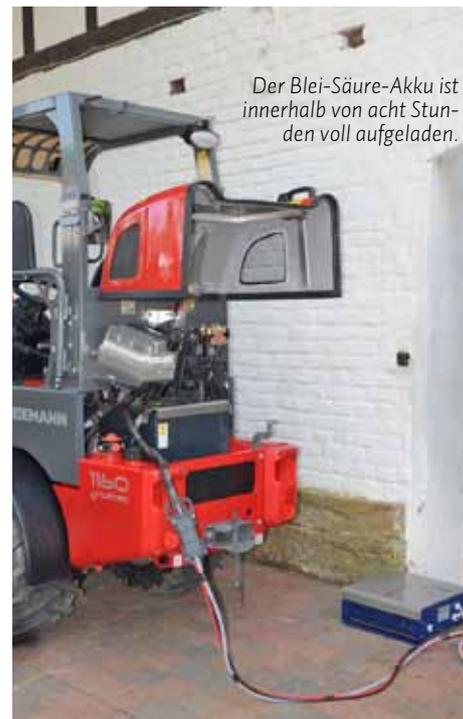
Der Blei-Säure-Akku ist innerhalb von acht Stunden voll aufgeladen.
