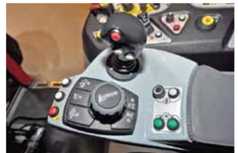
Der „L-Drive“-Drehregler vereinigt alle wichtigen Fahrfunktionen wie Wahl des Fahrmodus, Allradzuschaltung und Differentialsperre, Modulation von Fahrgeschwindigkeit, Beschleunigung und Motordrücke.
