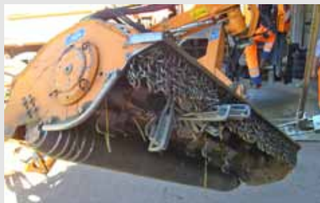
Am Randstreifen-Mähgerät des Unimog U500 sind Metalsteher eingeklemmt.
