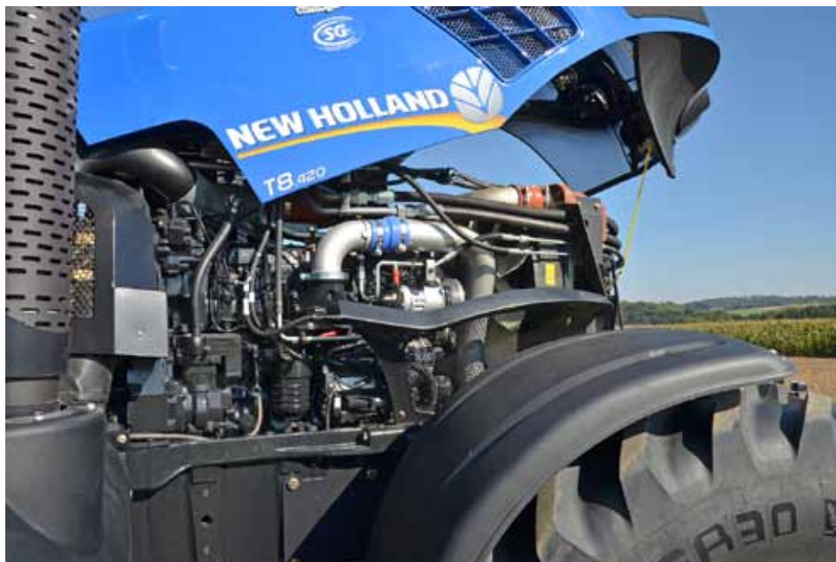
Sowohl für die schweren Straßenfahrzeuge als auch für den Offroadbereich haben die Motoren von Fiat Powertrain keine Abgasrückführung.
