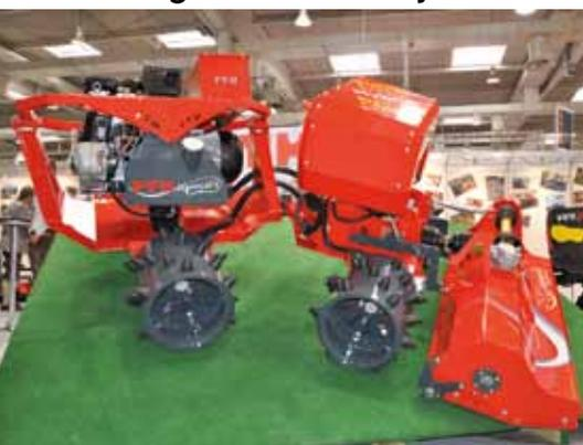
Mit dem PTH Hymog 301 präsentierte die Firma PTH auf der Agritechnica einen ferngesteuerten Böschungsmäher mit einer Mähbreite von 1350 mm. Der Hymog 301 verfügt über ein Schlegelmähwerk für das Mähen von Gras und Gestrüpp.
