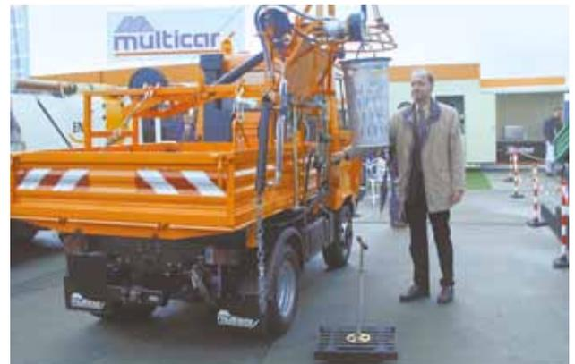
Der Sinkkastenreiniger bietet folgende unschlagbaren Vorteile:
