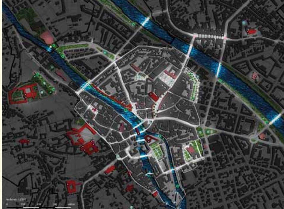
Viele Städte entwickeln Lichtmasterpläne (hier Bamberg) in denen neben den Leuchten auch Fragen der jeweils einzusetzenden Lichtfarbe, des Beleuchtungsniveaus und der gestalterischen Einbindung von Anstrahlungen und Illuminationen geregelt werden.
