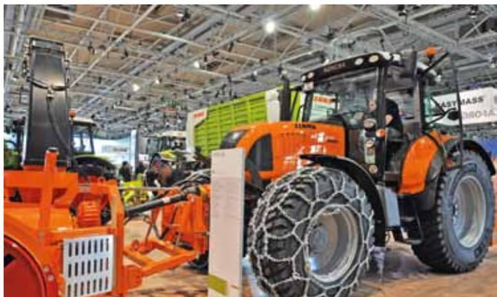
ausrüstung. Im Frontanbau befand sich eine Schneefrässchleuder FS 90 und im Heckanbau ein Traxos Streuautomat. Der Arion verfügt über einen kompletten Kommunalfestanbau mit Achsabstufung und Unterzug von Sauer.
