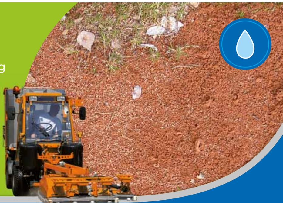
50 cm und einer Arbeitsgeschwindigkeit von 1,4 bis 2,4 km/h werden Flächenleistungen von 700 bis 1200 m<sup>2</sup>/h erreicht. Der Satz von zwei Pendelbürsten reicht für 500 bis 1000 m<sup>2</sup> und kann dann sehr leicht gewechselt werden. Der 6 PS starke 4-Takt-Motor ist stufenlos regelbar und der Bürstendruck ist zentral einstellbar. Ein Seitenschutz lässt sich komplett hochklappen, sodass auch an Rinnsteinen und Häuserkanten gearbeitet werden kann.
