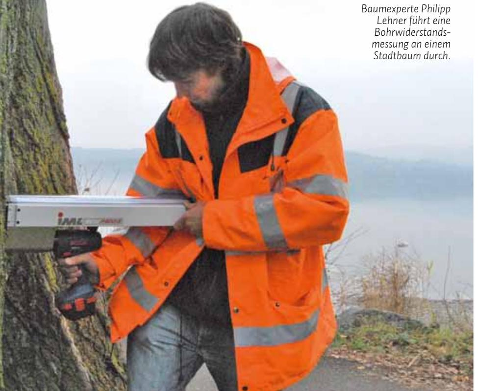
Baumexperte Philipp Lehner führt eine Bohrwiderstandsmessung an einem Stadtbaum durch.
