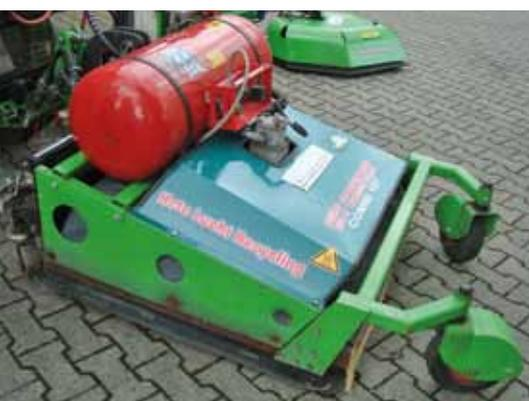
Die handgeführte Variante City Compact hat eine Arbeitsbreite von 80 cm und eine Flächenleistung bis 1.600 m<sup>2</sup>/h. Die Heißluft-Einheit ist um 45 Grad schwenkbar für Ecken und Kanten.
