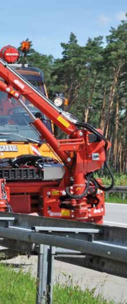
Punkt. Die Arbeit mit nur einem Mann auf dem Unimog wird möglich, weil der Randstreifenmäher nur in Position gebracht werden muss. Beim Arbeiten an Schutzplanken wird der Abstand mittels eines Ultraschallsensors automatisch eingestellt, dies ermöglicht, dass der am Randstreifenmäher angebrachte Tellermäher selbstständig um die Pfosten herumfährt. Der Fahrer kann sich somit auf die Führung des Auslegermähers konzentrieren.
