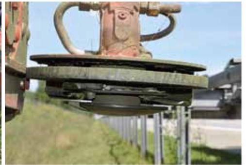
Seitlich an den Mähköpfen sind die Tellermäherwerke für das Ummähen der Leitpfosten und Schutzplankenhalter montiert. Sie laufen automatisch mit. Bei zu großem Anfahrdruck an schwenken sie zurück.
