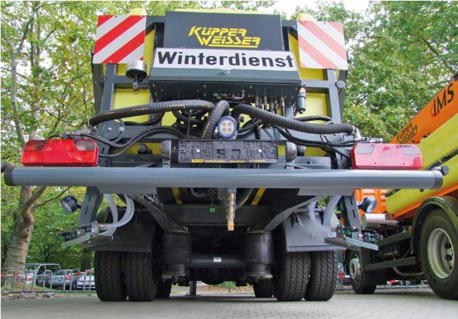
Anordnung der Düsen am Sole-Sprühgerät von Kupper-Weisser
