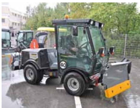
Der MIC 45 ist mit einem laut Kärcher drehmomentstarken 33-kW-Dieselmotor ausgerüstet. Das Multifunktions-Fahrzeug kann wahlweise mit einem Schneeschild, einem Mähdeck und weiteren Anbaugeräten versehen werden. Der An- und Abbau erfolgt werkzeuglos.
