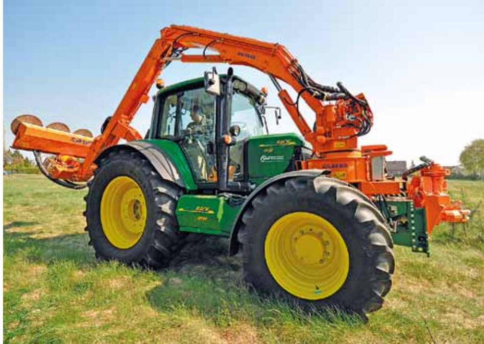
oben: Das zulässige Gesamtgewicht vom Reborack beträgt 10,5 t. Der 8,2 m Ausleger mit Anbaubock schlägt mit ca. 2,3 t zu Buche. Die Ölpumpe für die Betätigung des Auslegers und den Antrieb der Auslegergeräte wird über die Frontzapfwelle des Reboracks angetrieben.
