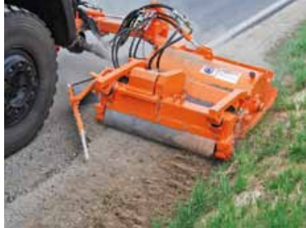
Neue Bankettfräse BF 1000 S mit integrierter Förderschnecke und Verdichterwalze
