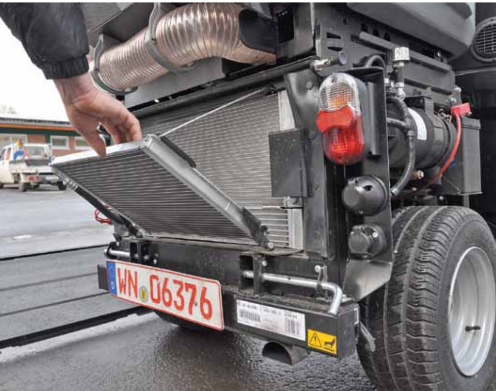
Der Yanmar Dreizylinder Dieselmotor leistet 26 PS. Die Kühler lassen sich zur besseren Reinigung auseinanderklappen.
