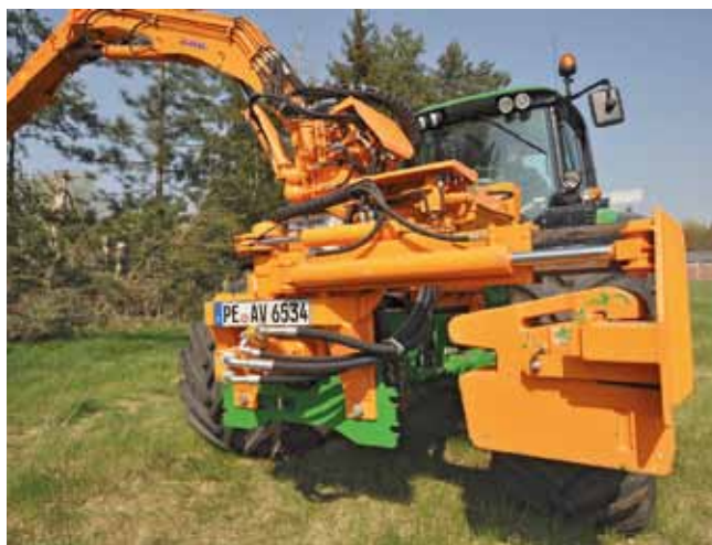
oben: Das zulässige Gesamtgewicht vom Reborack beträgt 10,5 t. Der 8,2 m Ausleger mit Anbaubock schlägt mit ca. 2,3 t zu Buche. Die Ölpumpe für die Betätigung des Auslegers und den Antrieb der Auslegergeräte wird über die Frontzapfwelle des Reboracks angetrieben.
