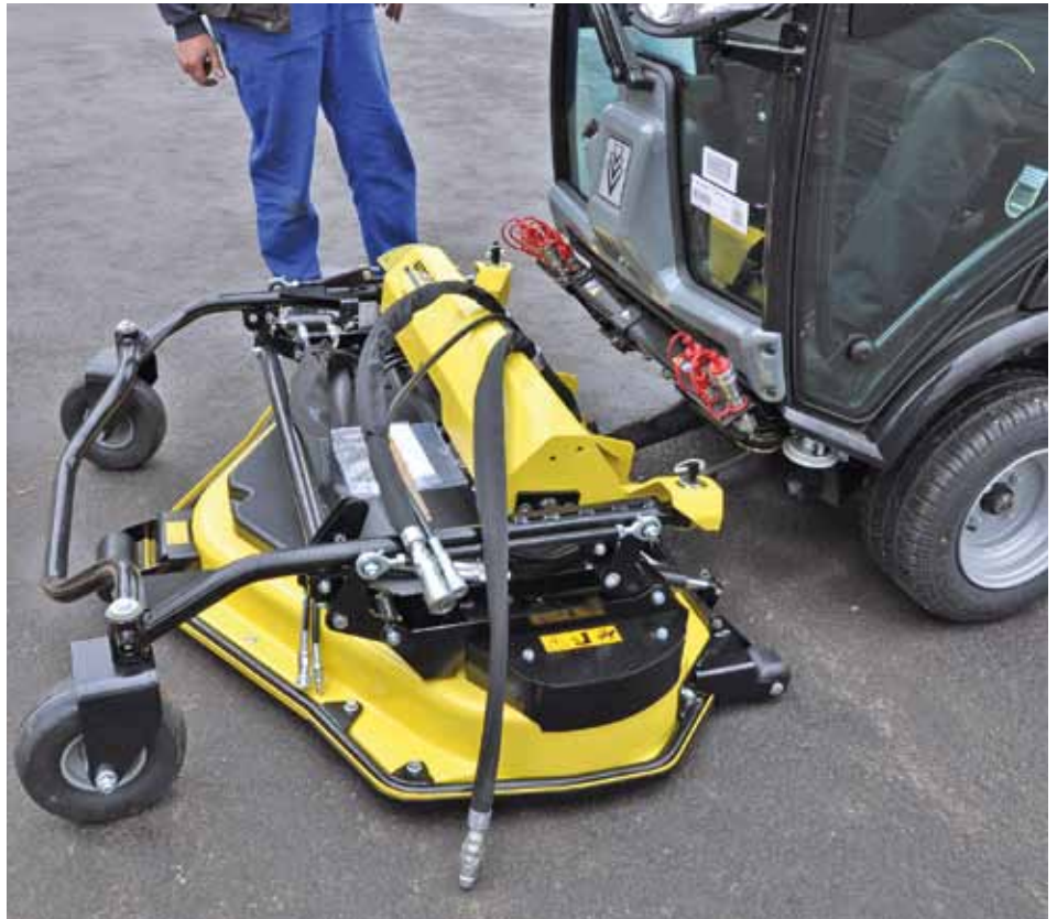
Das Mähdeck hat eine Arbeitsbreite von 1,35 m und arbeitet mit 3 Sichelmessern. Die Schnittqualität hat die Mitarbeiter vom Baubetriebshof Göttingen überzeugt – die Aushubhöhe weniger.
