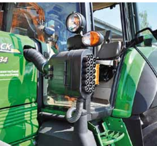
Die Vorderachse kann hydraulisch vom Fahrersitz aus verriegelt werden (oben). Die Kühlereinheit, der Lüfter und die Batterie finden beim Reborack einen neuen Platz im Zwischenachsbereich auf der rechten Schleppersseite (Mitte). Der Luftfilter befindet sich links vor der Kabine (unten).
