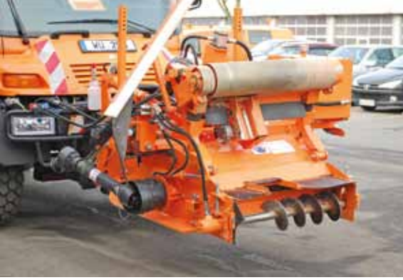
Neue Bankettfräse BF 1000 S mit integrierter Förderschnecke und Verdichterwalze
