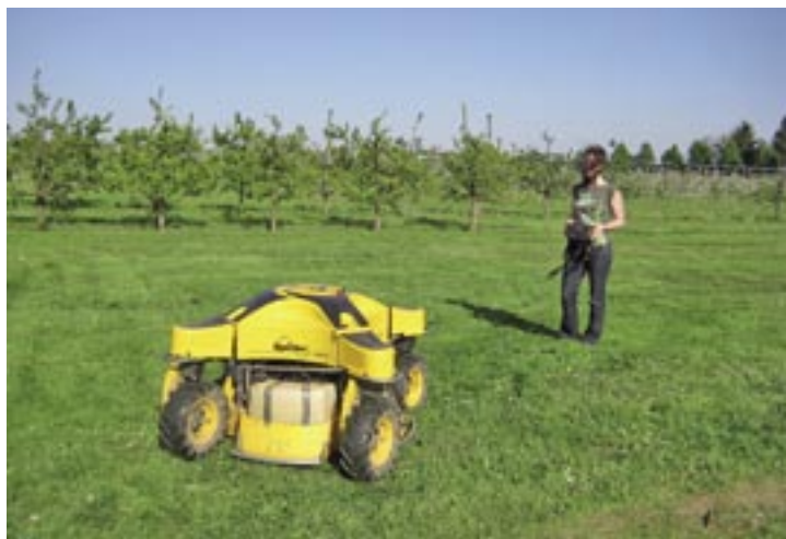
Während der Spider (links) ein funkferngesteuertes reines Mähgerät ist, handelt es sich beim Deltrak von Irus (rechts) um einen Geräteträger mit angebaute Mähwerk. (Bildquellen: Morhard)
