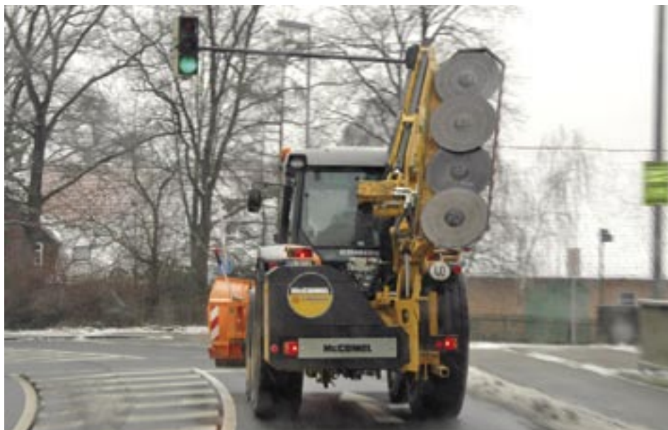
Der Fahrkomfort des Deutz-Fahr Agrofarm TTV 430 hat die Testfahrer überzeugt. Wenn Heckgeräte angebaut werden, sollte jedoch ein Kontergewicht in der Fronthydraulik eingehängt werden, da der Schlepper vorne relativ leicht ist.
