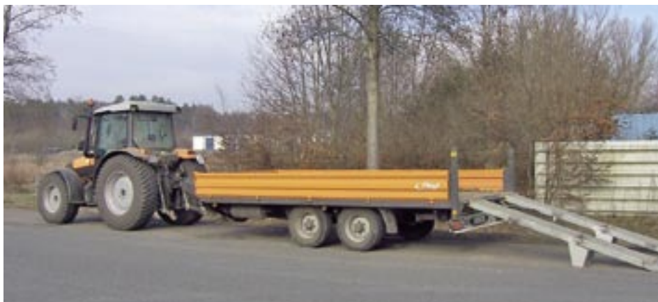
Für den Transport eines Mobilbaggers wurde ein Anhänger des Baubetriebshofes von 24-Volt auf 12-Volt umgerüstet, damit er mit dem Schlepper eingesetzt werden konnte.
