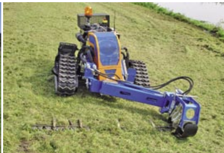
Während der Spider (links) ein funkferngesteuertes reines Mähgerät ist, handelt es sich beim Deltrak von Irus (rechts) um einen Geräteträger mit angebaute Mähwerk. (Bildquellen: Morhard)
