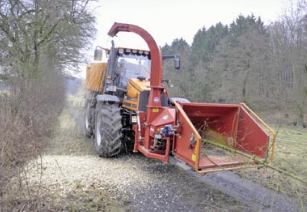
Mit dem Hacker können bis zu 20 cm dicke Stämme zu Hackschnitzeln verarbeitet werden.
