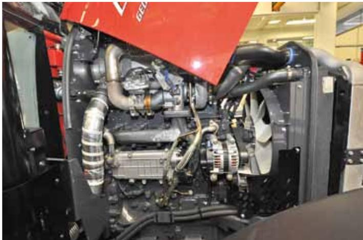
Beim „Geotrac 134 ep“ ist ein neuer 4.4 l Turbodieselmotor mit Commonrail Einspritzung von Perkins mit Dieselpartikelfilter und Abgasrückführung verbaut, so dass die Abgasnorm der Stufe 3b erreicht wird.
