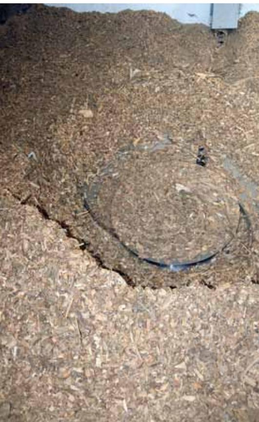
Das zugeführte Material muss absolut sauber sein, sonst kann es zu Störungen an den Zuführagregaten der Anlagen kommen.
