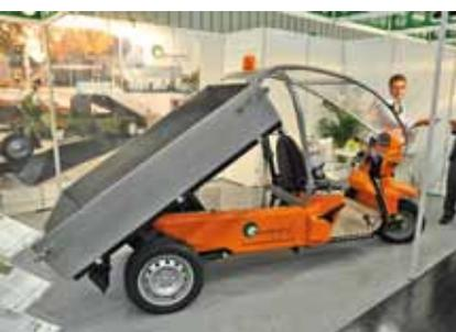
Die Firma e-Power-Drive hat auf der GaLaBau ein elektrisch angetriebenes Trike gezeigt, das über eine Ladefläche verfügt. Je nach e-Motor Ausstattung erreichen die Trikes eine Geschwindigkeit von 20 bzw. 45 km/h. Die Nutzlast liegt bei bis zu 500 kg. Die Reichweite gibt der Hersteller mit bis zu 120 km an. Die Fahrzeuge, die in Deutschland gefertigt werden, sind ab 9.990 Euro erhältlich.
