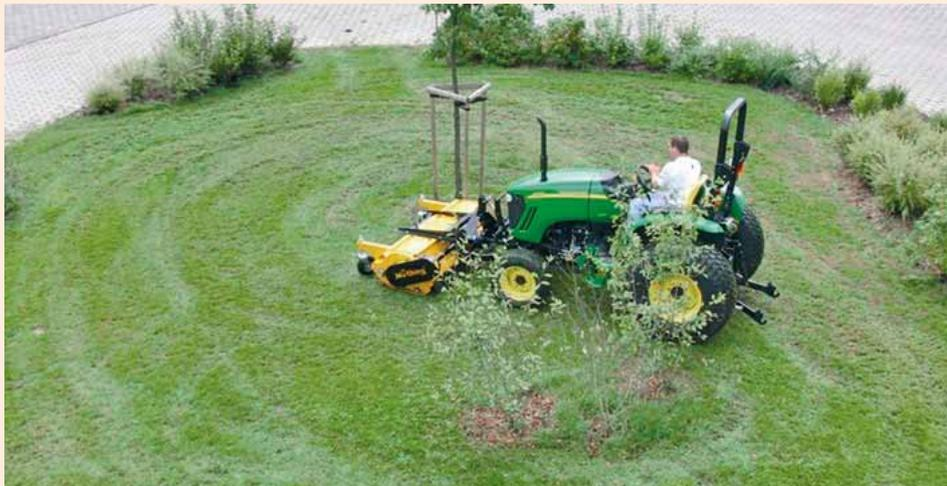
Der Schlegelmulcher von Mühling im Frontanbau mit Kurzhäckselleiste „Haifischflosse“ und Druckentlastungssystem MU-S O F A soll auch bei engen Flächen eine hohe Flächenleistung und einen sauberen Schnitt erreichen.
