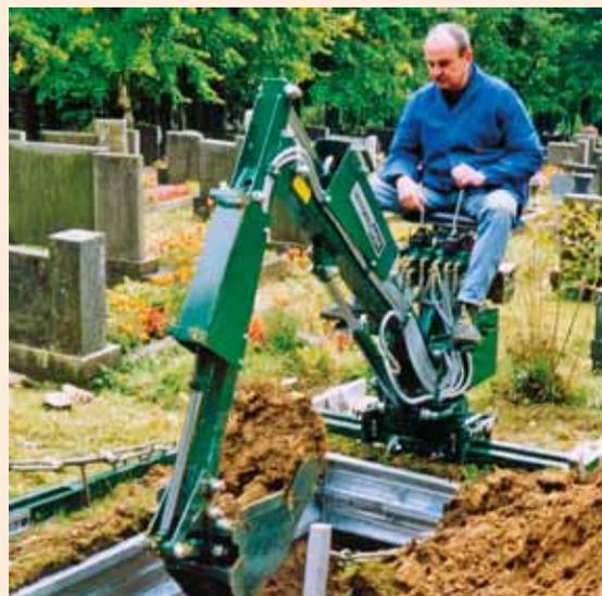
Der Friedhofsbagger Borer von Contex-Hydrobox mit hydraulischem Fahrtrieb
