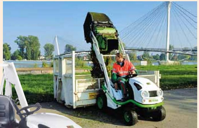
Etesia 100 mit Einzelradaufhängung an der Hinterachse und dadurch vergrößertem zentralen Heckauswurfkanal, Hydraulikantrieb der Hinterräder und Hochentleerung.
