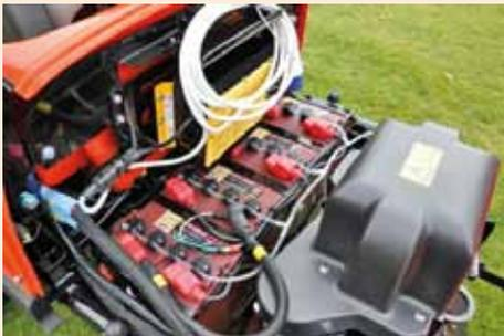
Jacobson Eclipse 322 als Hybridmäher mit elektrischem Fahr- und Mähantrieb (links) und als Elektromäher mit Batteriepack mit zentraler Befüllung.
