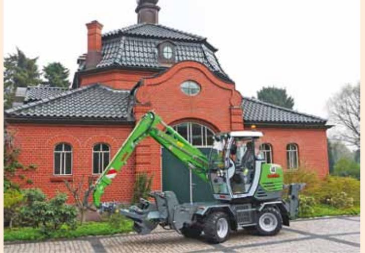
Der Fahrtrieb des Hansa Baggers wurde mit dem neu entwickelten GIT-Drive-Motordrehzahlreduzierung bis zu 30% bei Straßenfahrten, ausgerüstet.
