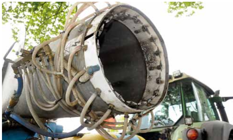
Das Bekämpfungsmittel wird durch Düsen am Ende eines langen Rohres mithilfe eines Ventilators, der das Sprühmittel vernebelt, mit hohem Druck an den Wirkort gesprüht.
