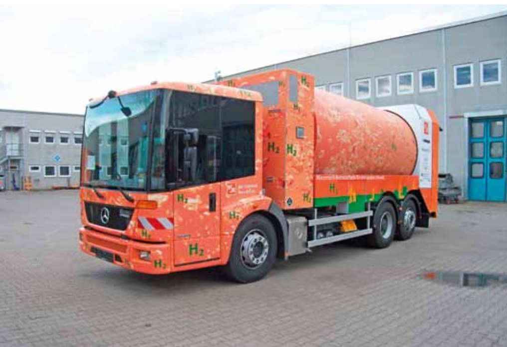
Das weltweit erste Brennstoffzellen-Müllfahrzeug von Faun ist bei der Berliner Stadtreinigung im Testbetrieb.
