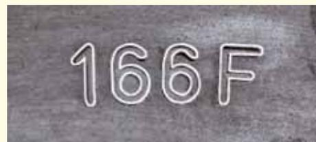
Die hier erkennbare Bezeichnung sagt aus, dass dieser Reifen bei maximalen 80 km/h eine Tragfähigkeit von höchstens 5.300 kg aufweist. Daneben findet sich noch der Hinweis, ob
