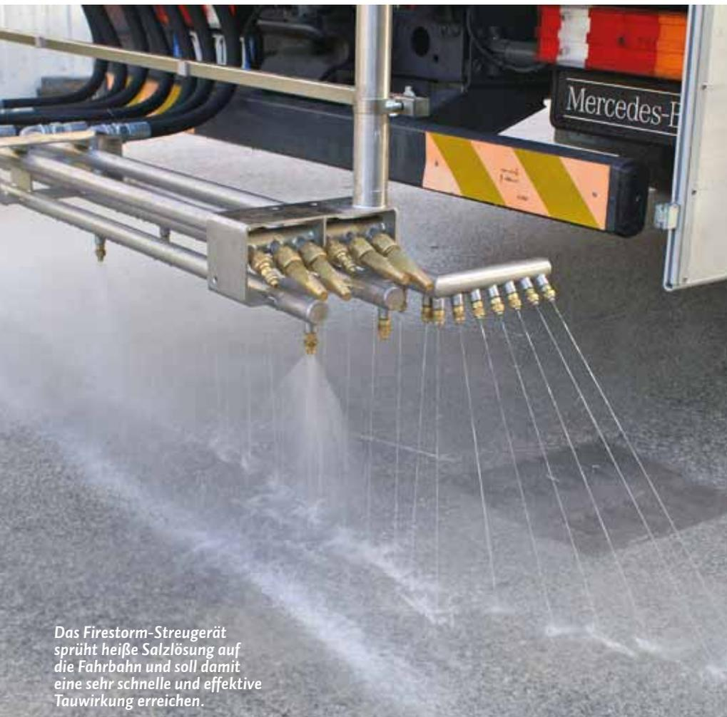
Das Firestorm-Streugerät sprüht heiße Salzlösung auf die Fahrbahn und soll damit eine sehr schnelle und effektive Tauwirkung erreichen.
