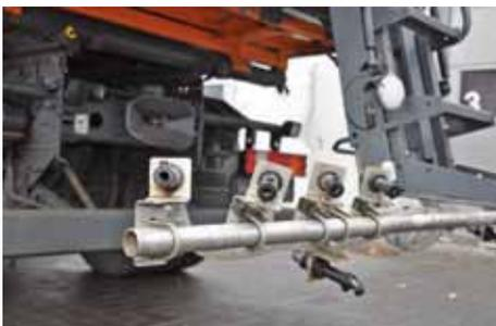
Laut Frank Müller ist die Sole-Ausbringtechnik weniger anfällig für Verschleiß als Streutechnik für Feucht- oder Trockensalz: „Bis auf den Düsenbalken sind alle Bestandteile aus Plastik und daher nicht rostanfällig.“
