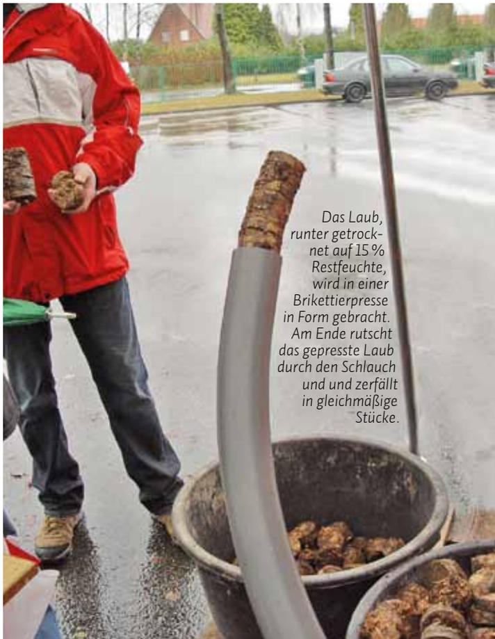
Das Laub, runter getrocknet auf 15% Restfeuchte, wird in einer Brikettierpresse in Form gebracht. Am Ende rutscht das gepresste Laub durch den Schlauch und zerfällt in gleichmäßige Stücke.
