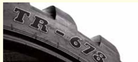
Eine weitere Kennzeichnung gibt Auskunft, dass es sich hier um einen Ackerschlepperreifen mit dem Profil TR – 678 handelt.
