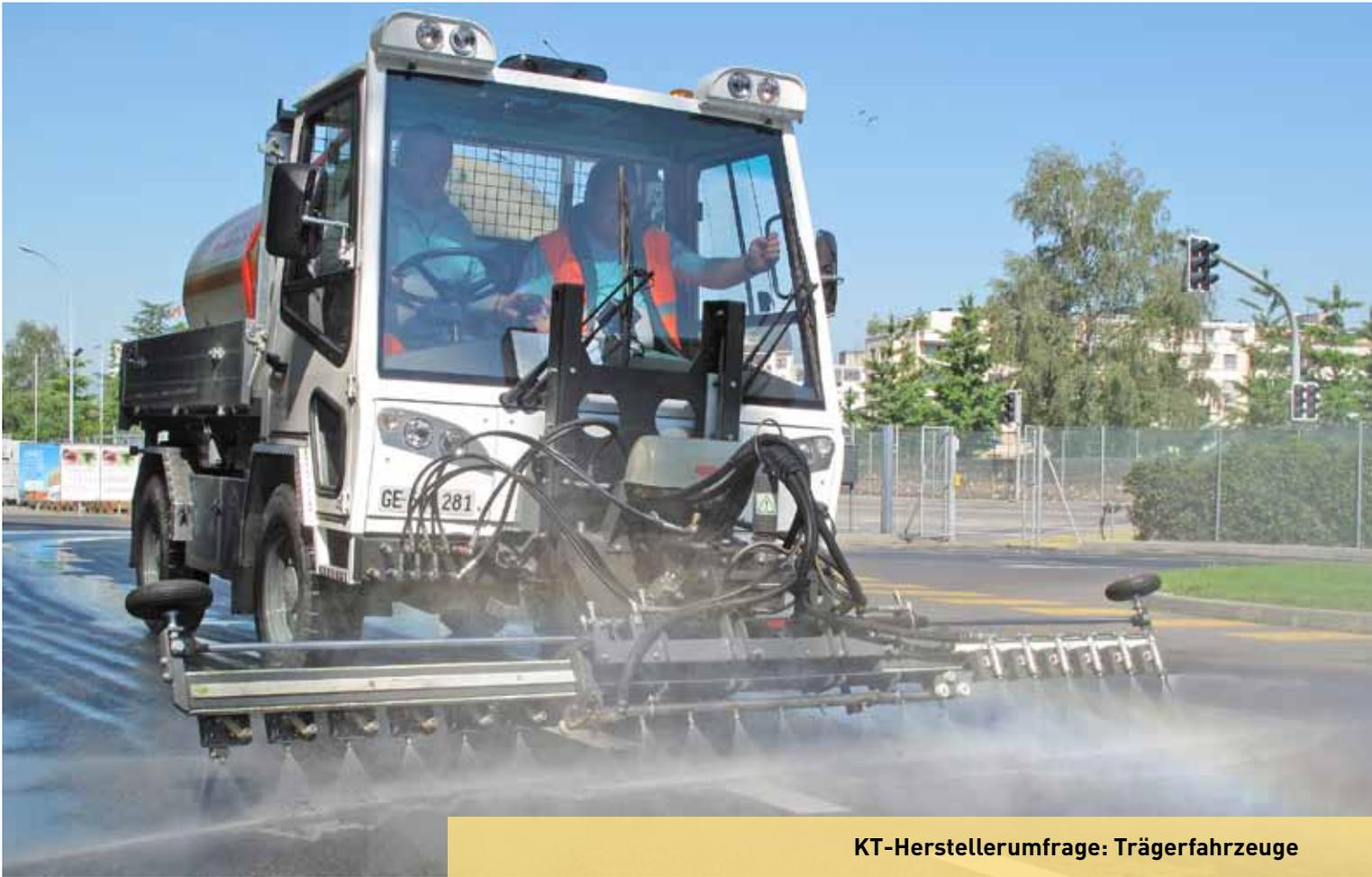
Mit bis zu 100 PS auf dem Nebenantrieb können laut V. Meili auch Anbaugeräte mit hohem Leistungsbedarf angebaut werden.
