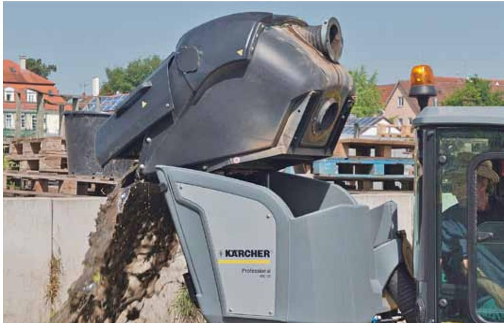
Die MC 50 kann hydraulisch hochentleert werden, in Ludwigsburg wird diese Möglichkeit aber nur selten genutzt.
