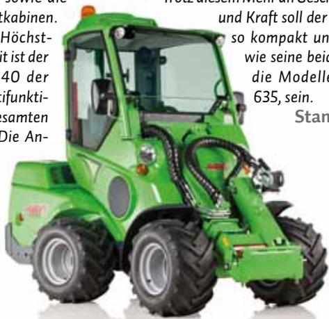
triebene Kolben-Hubmotoren mit zwei Fahrstufen und einer noch höheren Schubkraft, als sie bisher bei den beiden 600er Modellen vorhanden war. So soll der Anwender nicht nur ein schnelles, sondern auch einen laut Hersteller geländegängigen und kraftvollen Multifunktionslader zur Verfügung haben. Trotz diesem Mehr an Geschwindigkeit und Kraft soll der Avant 640 so kompakt und handlich wie seine beiden Brüder, die Modelle 630 und 635, sein.
