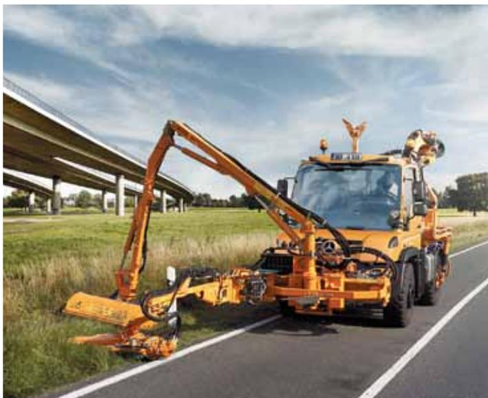
Der neue U 530 wartet unter anderem mit 299 PS Motorleistung und einer verbesserten Arbeitshydraulik auf.
