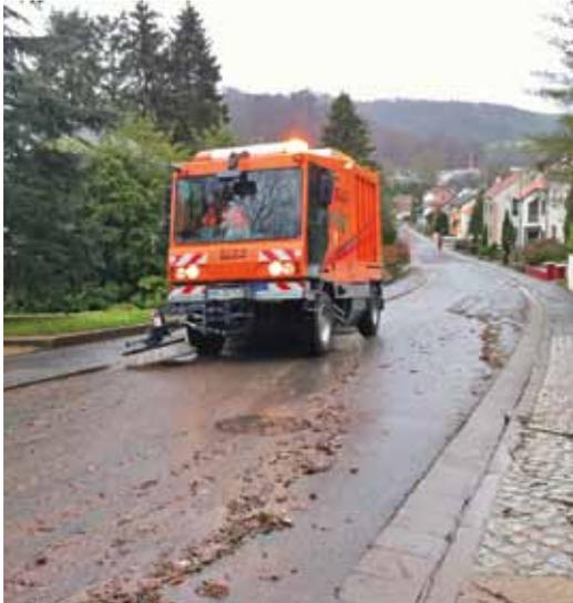
Die Dulevo Kehrmaschine kommt durch das Paternoster-Transportsystem auch gut unter sehr feuchten Bedingungen zurecht.
