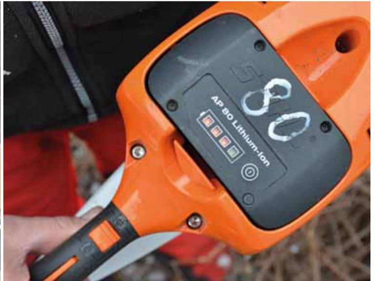
Sämtliche Akkus von Stihl verfügen über eine gut sichtbare Ladestandsanzeige (links). Leuchtet diese rot, ist eine Störung aufgetreten und der Akku schaltet sich ab. Dies passierte im KT-PraxisTest gelegentlich, wenn die Temperaturen deutlich unter 0° lagen.
