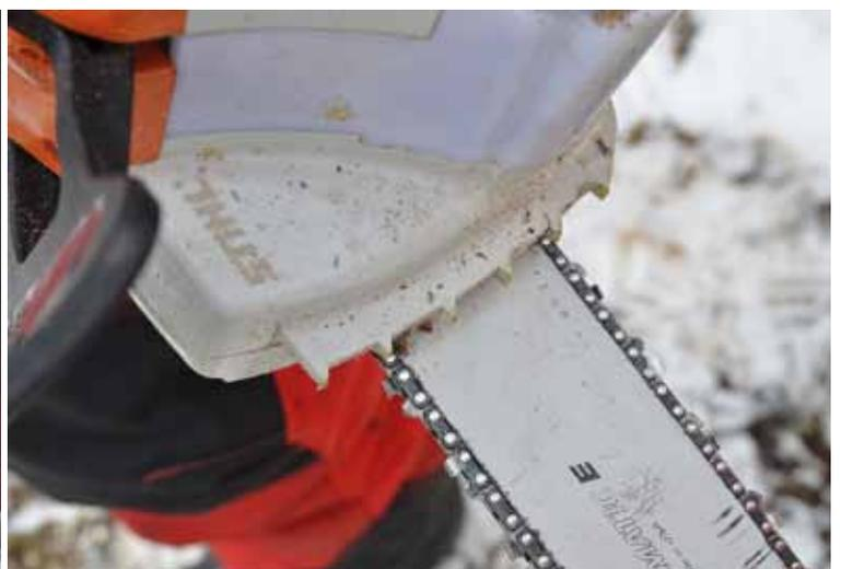
Zwei Kritikpunkte hatten unsere Tester bei der MSA 200 C: Die Ergonomie des Sperrknopfes, der mit dem Daumen gedrückt werden muss (links) und die Baumkralle, die in das Kunststoffgehäuse der Säge integriert ist.
