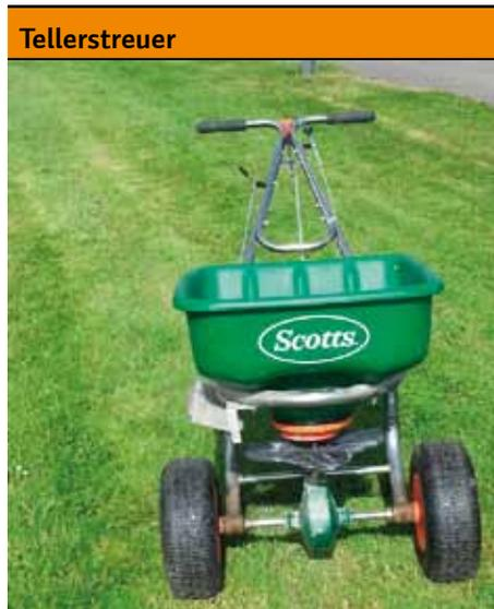
Streugut rieselt durch einstellbare Öffnungen aus dem Behälter auf radangetriebenen rotierenden Streuteller und wird kreisförmig ausgeworfen.
