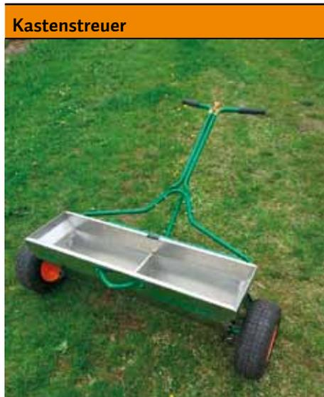
Prinzip des freien Ausfallens aus dem Behälter durch verstellbares Lochblech an der Unterseite, radangetriebene Mischwelle sorgt für gleichmäßige Verteilung und Durchmischung im Streugutkasten und mindert die Verstopfungsgefahr.
