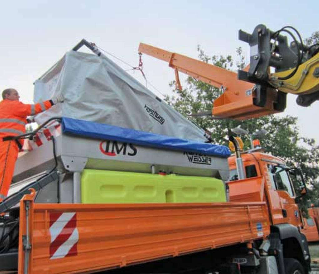
Mithilfe eines Kranes, hier ein Teleskopradlader mit Aufsteckkran, wird der flexible Soletank in die Wanne des Feuchtsalzstreuers eingelassen.
