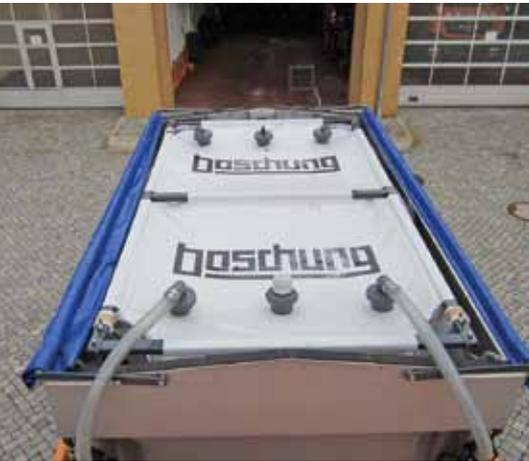
Das System von oben. Dank der Schwerkraft wird die Sole ohne Hilfe von zusätzlichen Pumpen zum Sprühbalken transportiert.
