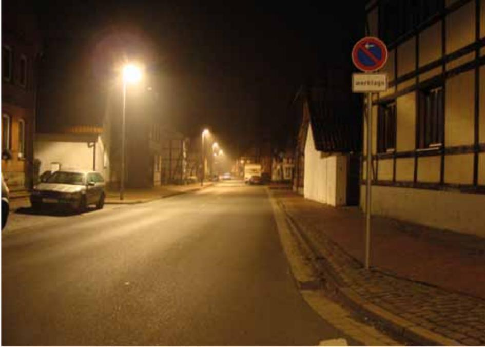
Vor der Sanierung kamen an dieser Straße 125 W Quecksilberdampf Lampen zum Einsatz, deren Lichtstrom im Laufe der Nutzungszeit stark nachließ (unten nach ca. 12.000 h Betrieb). Nach der Sanierung werden nun Cosmopolis Lampen genutzt, die bei einer Leistungsaufnahme von 45 W für eine bessere Ausleuchtung sorgen (links).
