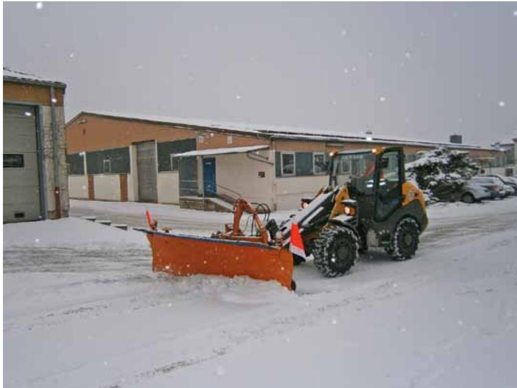
Der Ahlmann-Radlader, Baujahr 2010, wird zum Schneeschieben sowie zum Beladen der Streufahrzeuge genutzt.
