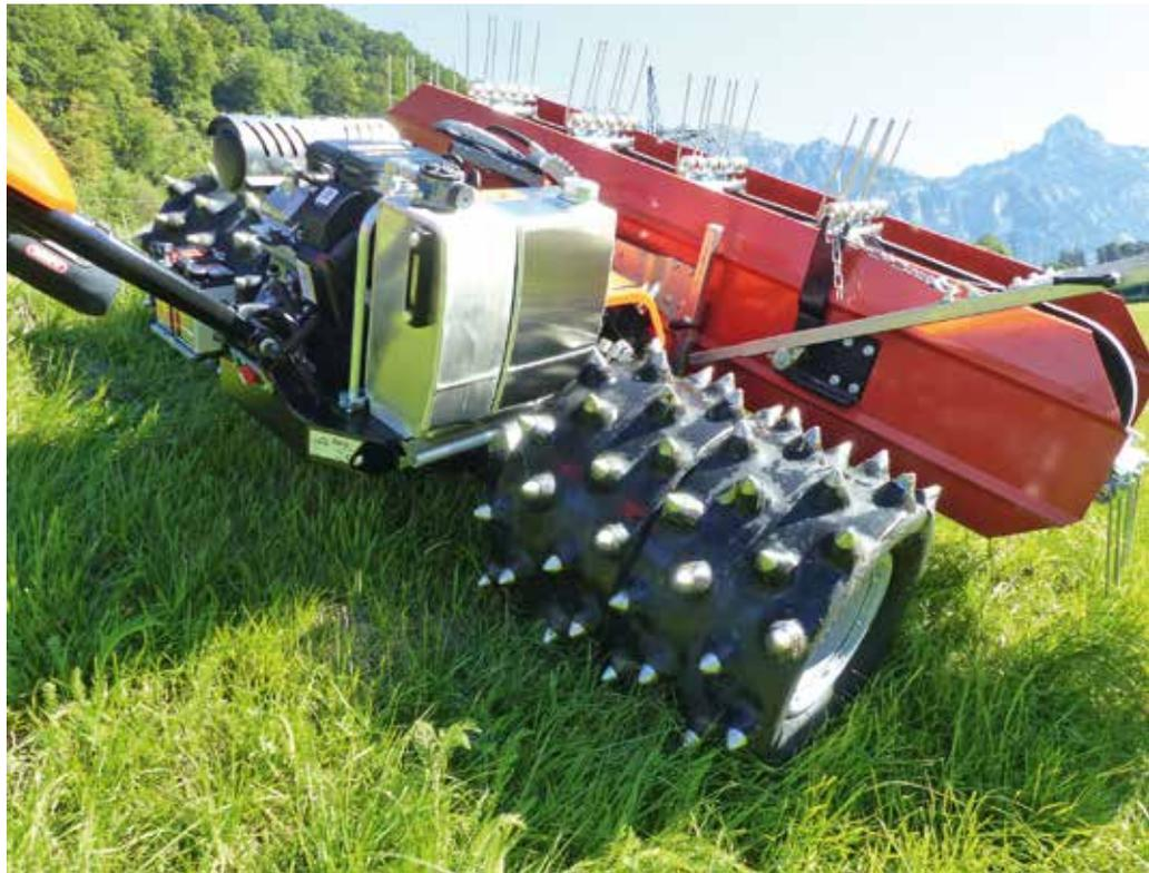
wendet werden. Die Verbindung von Felge und Reifen erfolgt über einen verschraubten Ring. Dies ist nötig, da ja ohne Druck gefahren wird.
