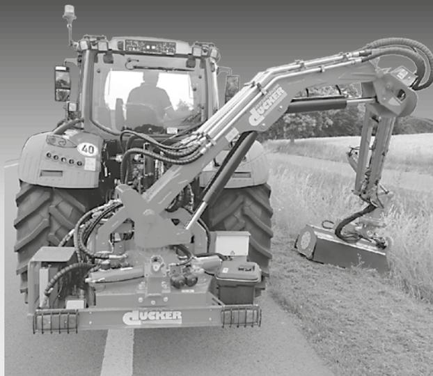
Die Ausleger HDM 600 und 700 sind für den Heckanbau an Traktoren konzipiert. Die wesentlichen Pluspunkte:
