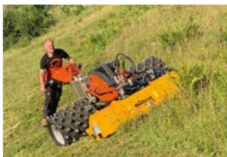
Ein Ibox Motormäher mit den Gummistachelwalzen im Hangeinsatz.
